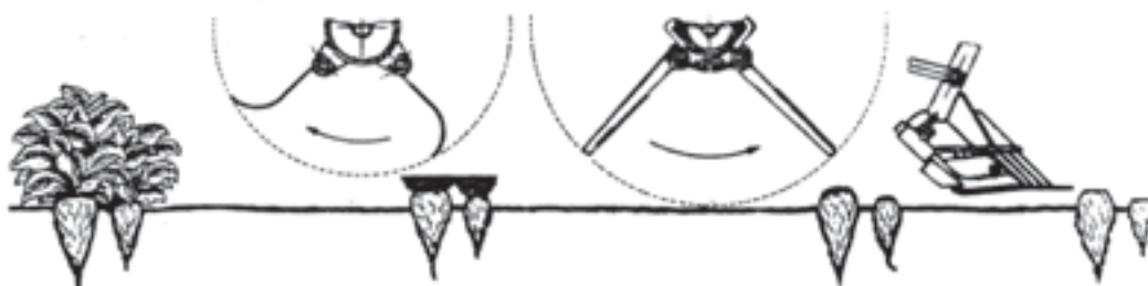
شکل ۲۶-۱- تنظیم فلکه انگشتی
