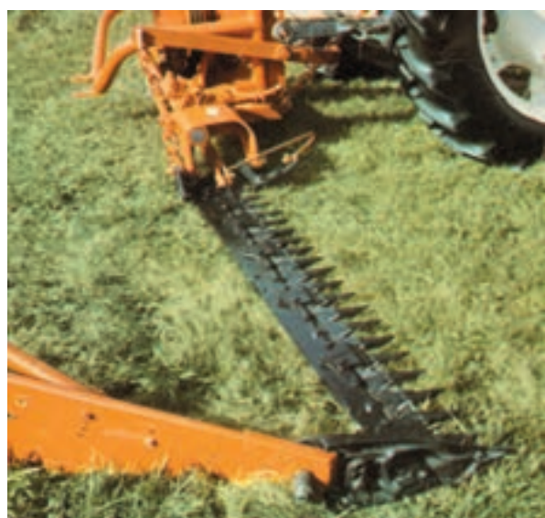
شکل ۱-۸- دروگر شانهای تراکتوری
