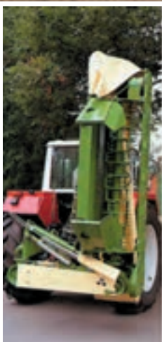
شکل ۱۴-۱- دروگر دوار
