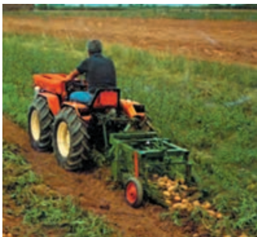
شکل ۱-۲۹- نوع دیگر غده کن در حال کار
