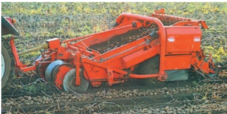
شکل ۱-۲۸- سیب زمینی کن در حال کار
