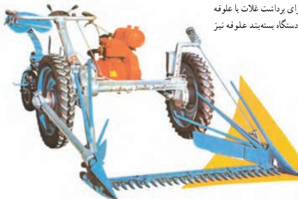
شکل ۱۷-۱- دروگر موتوربایندر
