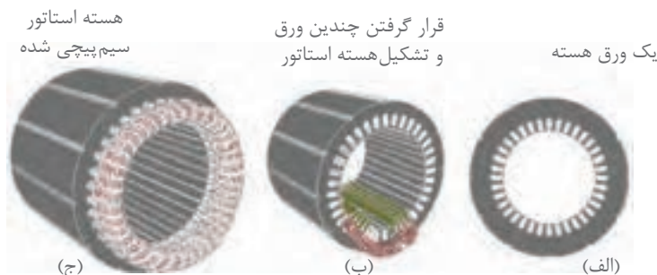
شکل ۵- اجزای استاتور موتورهای آسنکرون
