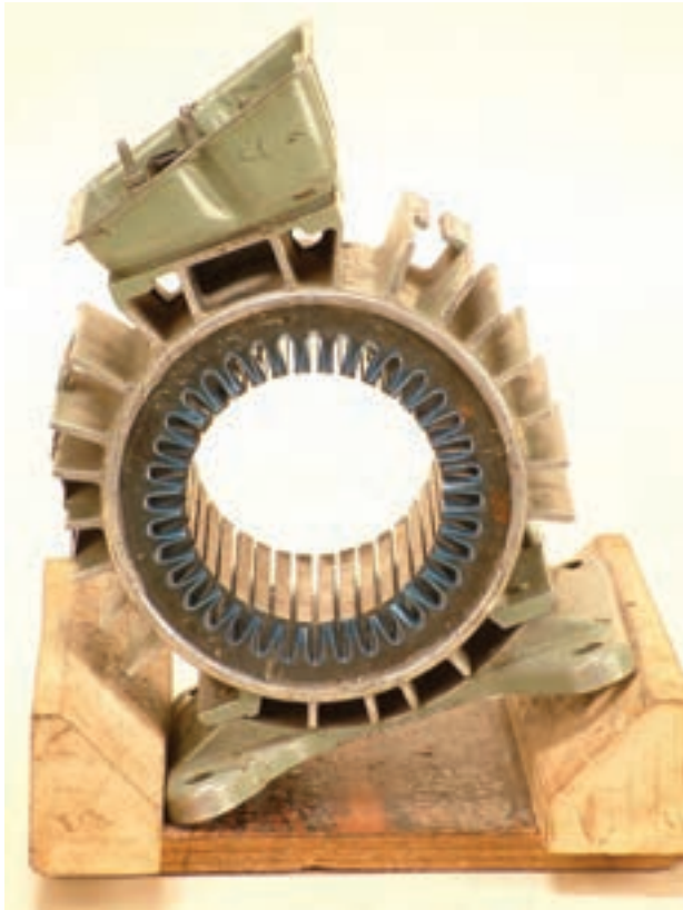
شکل ۲۹-۲-ب - انتخاب شیار شروع سیم‌بندی
