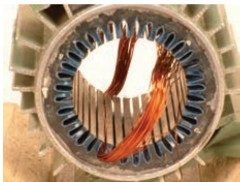
شکل ۲-۱۰ طول کاغذ پرشمان از هر طرف شیار حدود ۲ تا ۲/۵ میلی‌متر بیشتر است.
