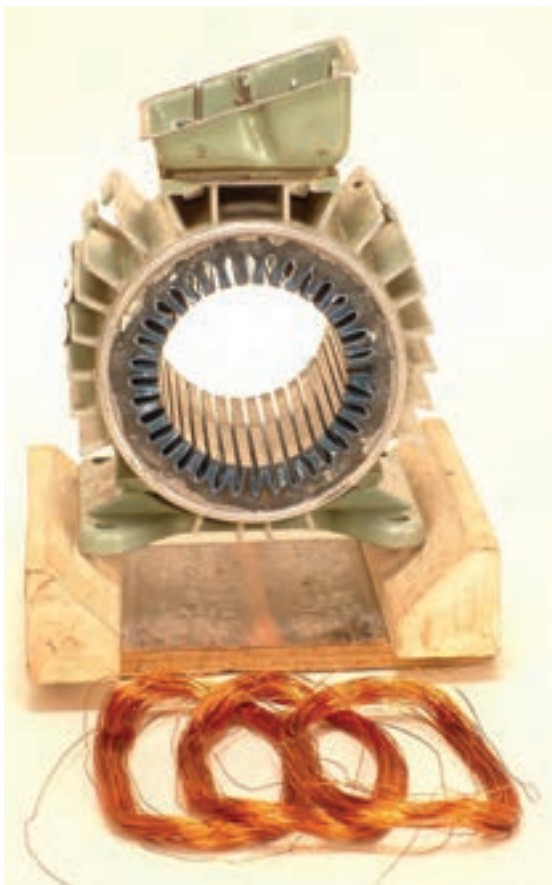
شکل ۲-۱۴- تعیین محل قرار گرفتن کلاف ها
