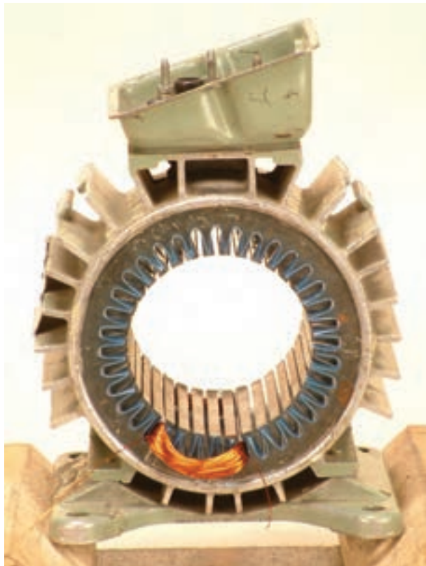
شکل ۲۹-۲-ج - قراردادن کلاف شماره ۱
