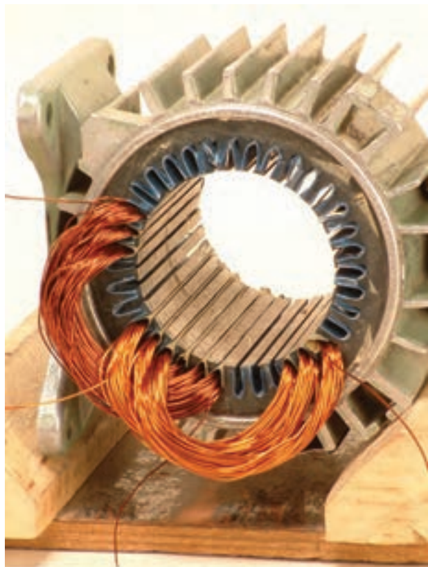
شکل ۲-۲۲- شروع گروه کلاف سوم از شیار شماره ۱۳
