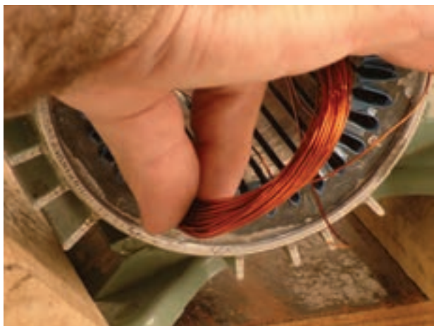
شکل ۲-۱۵- قراردادن بازوی شماره یک در شیار شماره ۱
