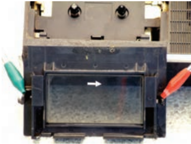
شکل ۱-۲۲- بررسی انبرهای نگه‌دارنده در ضبط صوت
