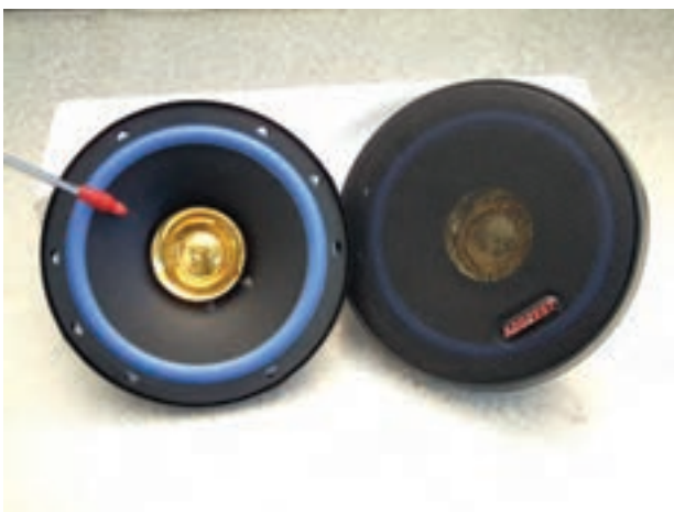
شکل ۱-۳۷ خود بلندگو را از نظر وجود سوراخ، آسیب‌مخروط، جدا شدن و یا قطع شدن در سیم پیچ بررسی کنید.
