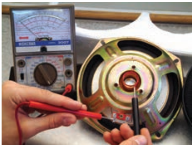
شکل ۱-۳۹- اندازه‌گیری مقاومت بلندگو
