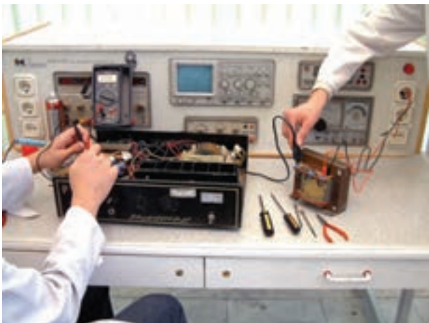
شکل ۲-۸۶- اگر به تعمیر لوازم الکترونیکی می پردازید باید ترانسفورمر ایزوله کننده را مورد استفاده قرار دهید تا دستگاه تعمیری و مورد آزمایش از فاز و نول شهر مستقل شود.
