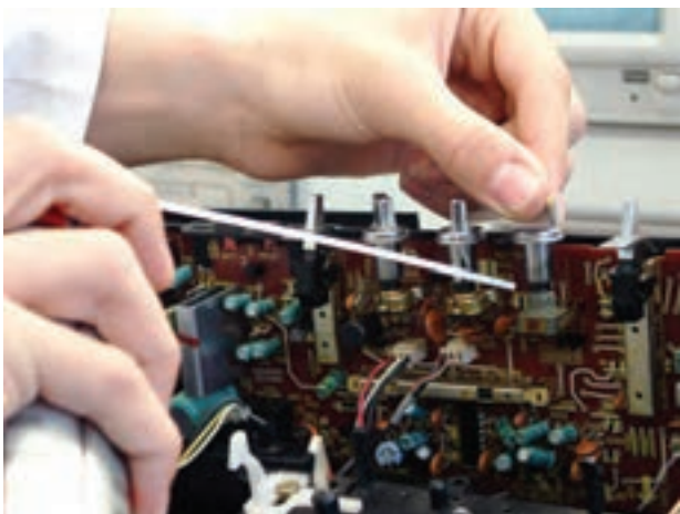
شکل ۱-۲۸- نحوه‌ی شست‌وشو کلیدها و ولوم‌ها
