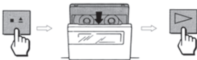
شکل ۴۴-۵- قرار دادن نوار آزمون در دستگاه ضبط و انتخاب حالت پخش صدا
