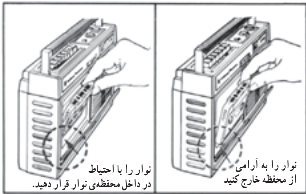
شکل ۱۷-۴- روش صحیح قرار دادن نوار در دستگاه
