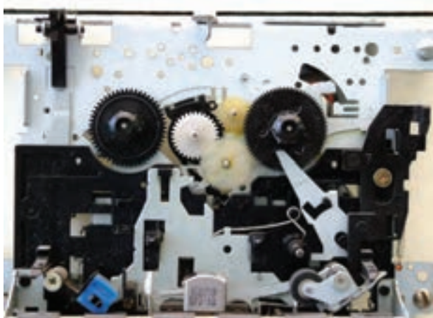
شکل ۴-۶۱- نباید برای سریع‌تر شدن حرکت نوار، غلتک جمع‌کننده، قرقره‌ی منبع، پولی راه‌انداز و چرخ‌دنده‌های پلاستیکی را روغن‌کاری کنید.
