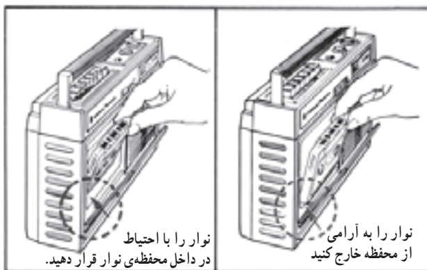
شکل ۲-۸۷- روش صحیح قراردادن نوار در دستگاه
