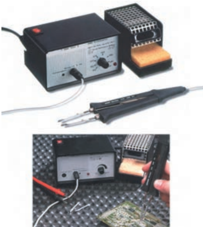
شکل ۵-۸- ابزار مورد نیاز برای کشیدن قطعات SMD از روی بُرد
