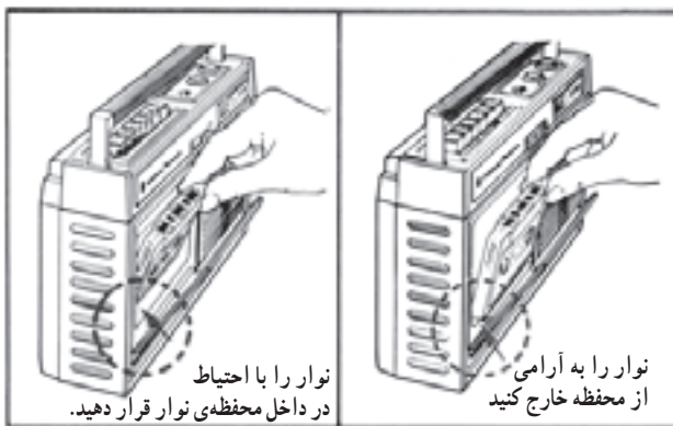
شکل ۲۱-۵ روش صحیح قرار دادن نوار در دستگاه
