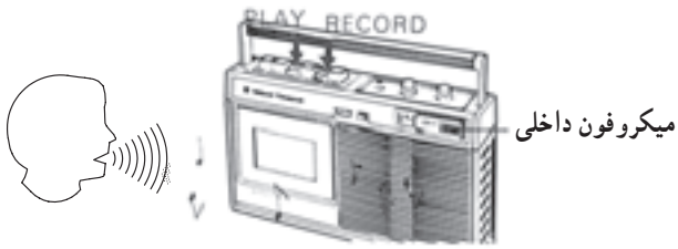
شکل ۲۶-۴ ضبط سیگنال از طریق میکروفون داخلی
