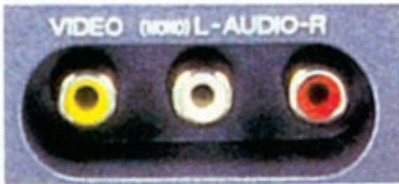
شکل ۶-۴- فیش های گوشی، میکروفون و خط صوتی و تصویری
