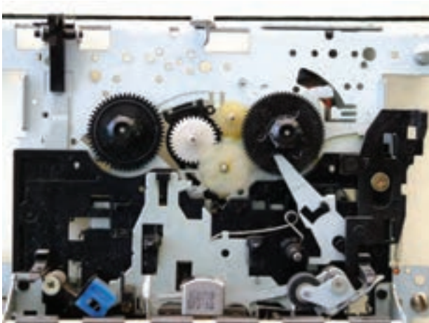
شکل ۳-۱- سیستم مکانیکی ضبط صوت
