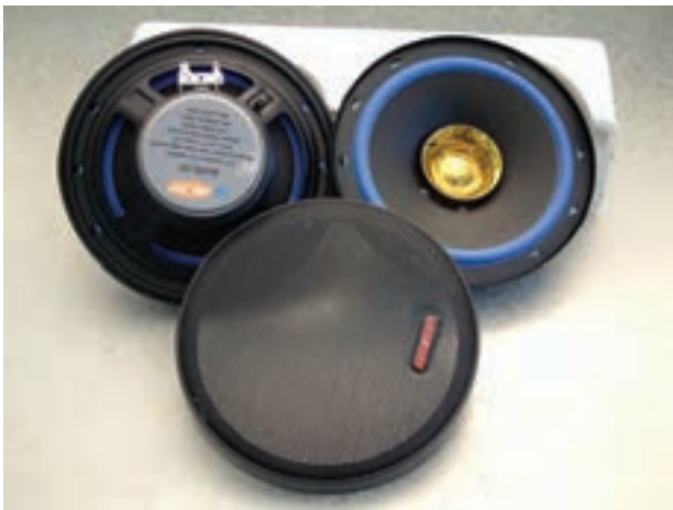
شکل ۱-۳۶ در مواردی که صدا قطع و وصل می‌شود باید اتصال‌های بلندگوها، مدارهای کنترل، سیم پیچ‌های صوتی و کابل‌ها را بررسی کنید.
