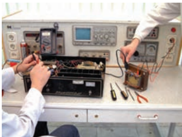
شکل ۱-۴۲- اگر به تعمیر لوازم الکترونیکی می پردازید، ترانسفورماتور ایزوله کننده را مورد استفاده قرار دهید.
