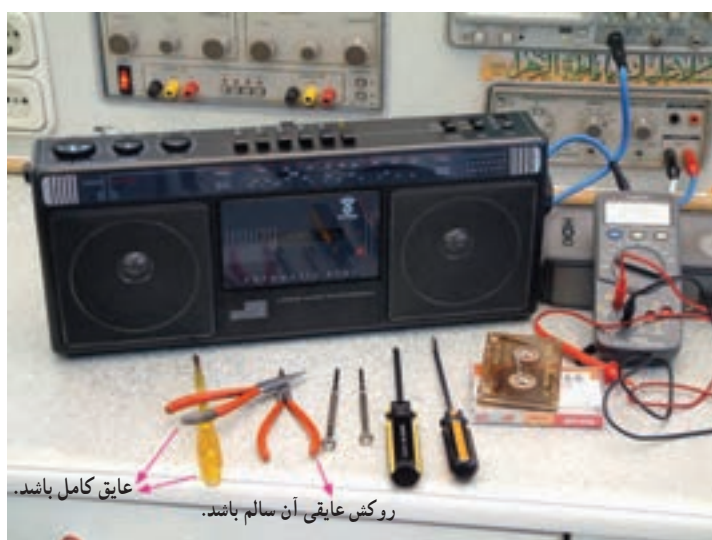
شکل ۱-۴۰- وسایل و ابزار مخصوص تعمیرات الکترونیکی
