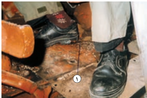
۱- اهرم وضعیت محور انتقال نیرو شکل ۱۲۲
