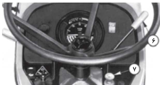
۶ — اهرم گاز دستی ۷ — اهرم خاموش کن
