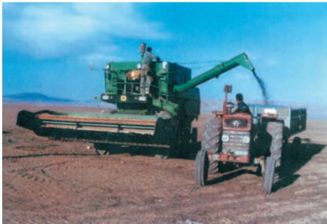
شکل ۶-۷ خالی کردن مخزن کمباین از دانه‌های آفتابگردان
