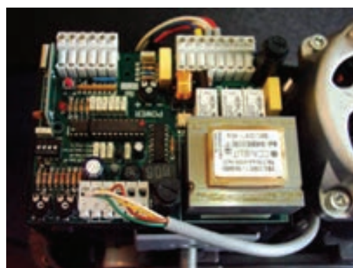
شکل ۱۸-۴ برد الکترونیکی در اتوماتیک ریلی
