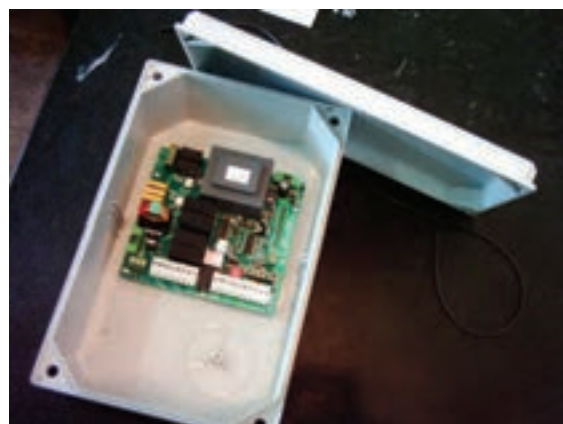
شکل ۱۷-۴ برد الکترونیکی در اتوماتیک لولایی
