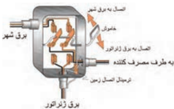
شکل ۱۷-۵ کلید تعویض دو طرفه تک فاز
