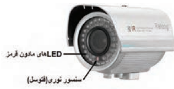
شکل ۳-۹ لامپ (LED) های تولید کننده نور مادون قرمز
