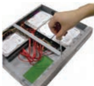
شکل ۶۸-۳ دیسک سخت نصب شده در داخل دستگاه
