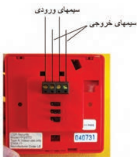
شکل ۳۹-۱ سیم‌های اتصال شستی
