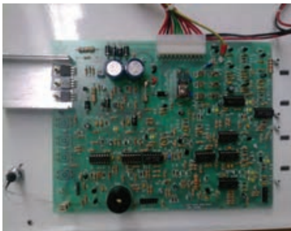
شکل ۱-۲۹ مدار الکترونیکی یک نمونه تابلو اعلام حریق
