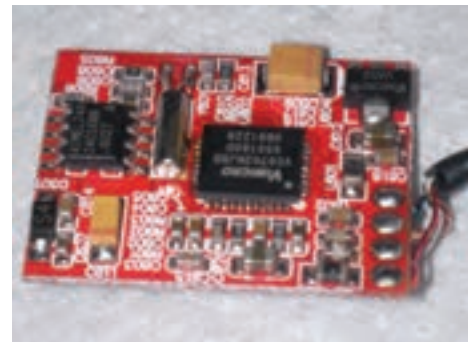
شکل ۳-۲۵ مدار الکترونیکی دوربین
