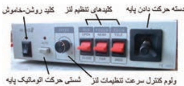
شکل ۳-۵۵ قسمت‌های مختلف جلو کنترل‌کننده
