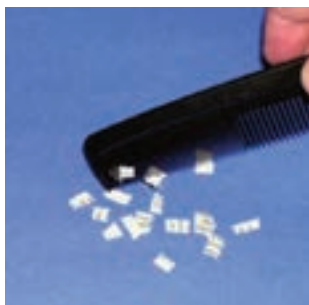
▶ شکل ۲-۱۰۷ ایجاد الکتریسیته ساکن در اثر اصطکاک
