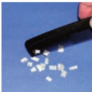
▶ شکل ۱۰۷-۲ ایجاد الکتریسیته ساکن در اثر اصطکاک
