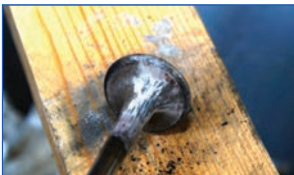
(ب) سوپاپ تمیز شده با کاردک
