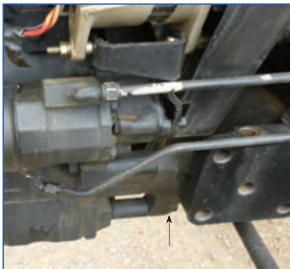
شکل ۱۷-۳- محل پیچ‌های اتصال موتور به جلوی تراکتور
