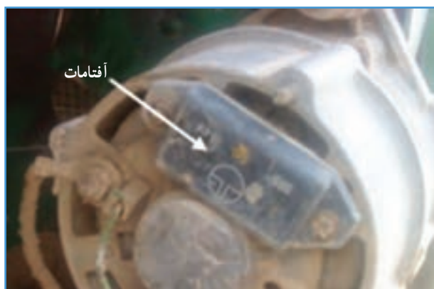
الف) آفتامات روی آلترناتور تراکتور JD3140
