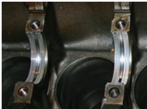
شکل ۱۸۵-۴ جازدن یاتاقان‌های ثابت
