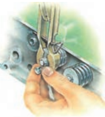
شکل ۴-۱۸- نحوه خارج کردن خار سوپاپ
