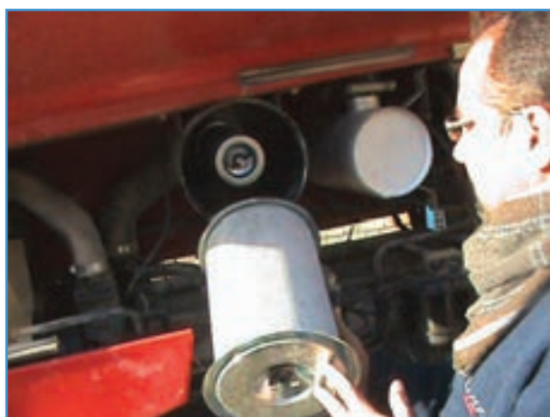
شکل ۵-۱۲ باز کردن مهره نگهدارنده و خارج کردن صافی
