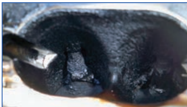
الف) کربن محفظه پشت سوپاپ‌ها
