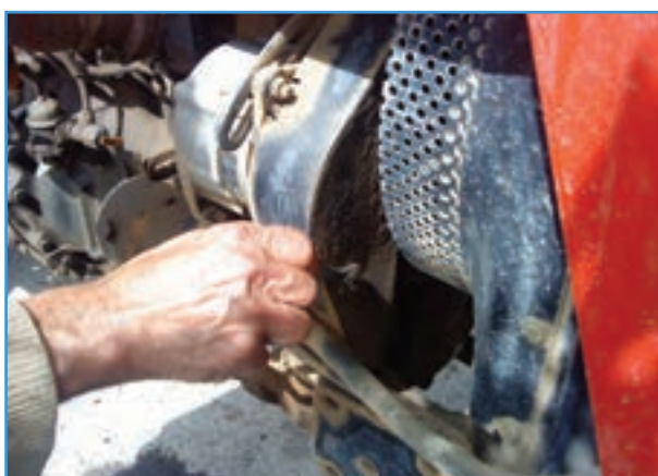
شکل ۳۲-۶ باز کردن روکش محافظ تسمه
