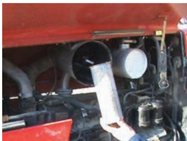
الف) خارج کردن صافی ثانویه
