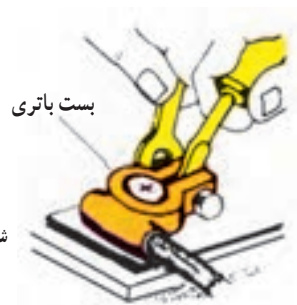
شکل ۶-۶ باز کردن پیچ و مهره بست باتری
