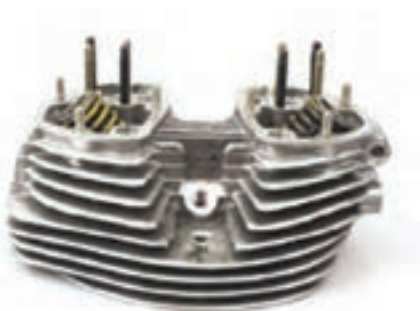
شکل ۳-۲ - سرسیلندر موتور هوا خنک
