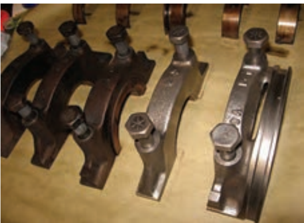
شکل ۱۵۴-۴- چیدن کپه یاتاقان‌ها
