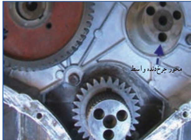
شکل ۶۷-۴ چرخ‌دنده واسط برداشته شده است.
