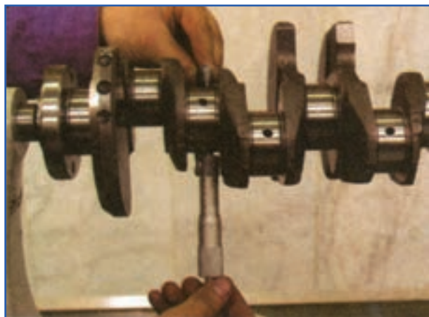
شکل ۱۶۲-۴ اندازه گیری قطر محورها میل لنگ
