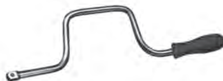
شکل ۴۲-۳- دسته بکس هندلی
