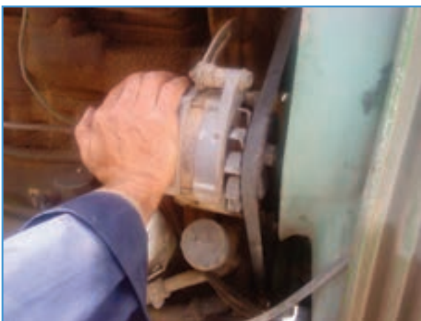
شکل ۳۰-۶ فشار دادن آلترناتور به عقب
