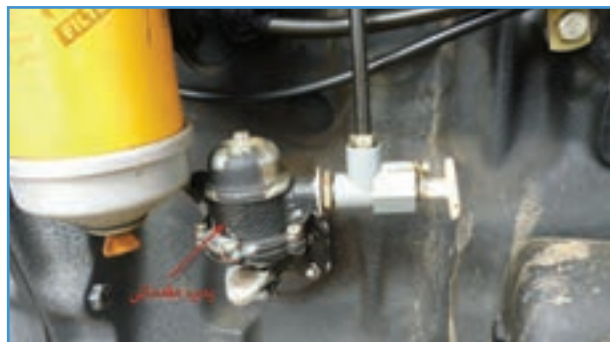
شکل ۲۹-۲ پمپ مقدماتی تراکتور MF285
