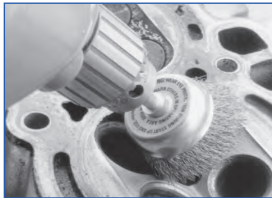
شکل ۴۱-۴- تمیز کردن اتاق احتراق
