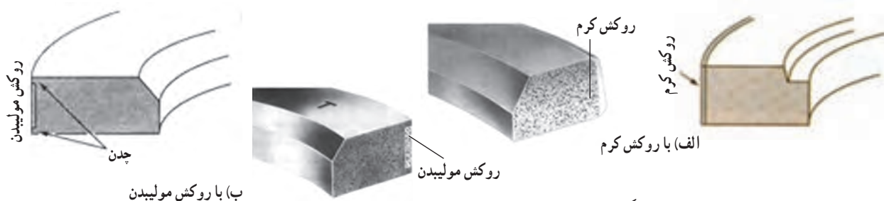
شکل ۲۴-۲ مقطع رینگ‌های تراکم روکش‌دار
