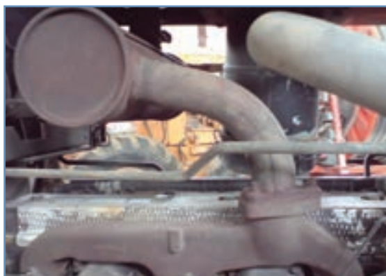
شکل ۳۰-۵- محل اتصال منبع اگزوز به مانیفولد
