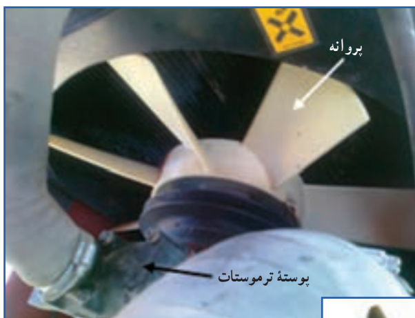
شکل ۳۵-۲ پمپ آب تراکتور
