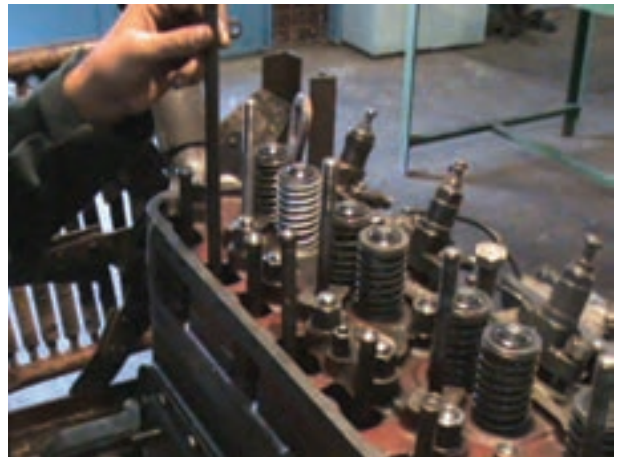
الف) برداشتن میل تایپت
