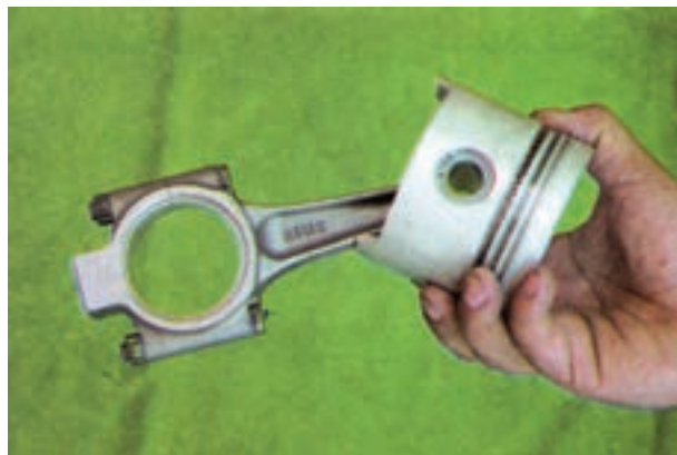
شکل ۱۲۶-۴ طرز آزمایش لقی شاتون روی انگشتی
