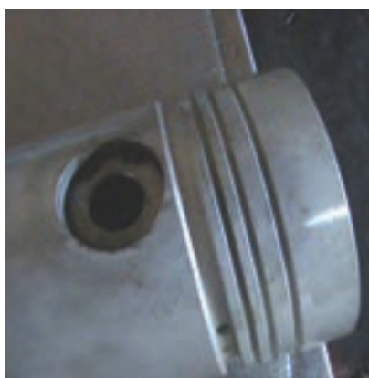
شکل ۱۲۳-۴ میزان داخل شدن انگشتی در پیستون
