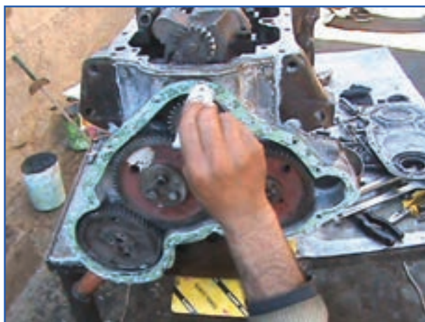
شکل ۴۴-۷- چسب زدن به محل نصب سینی جلو
