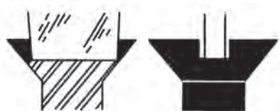
شکل ۷۱-۳ طرز قرار گرفتن لبه پنج گوشتی در شیار پنج
