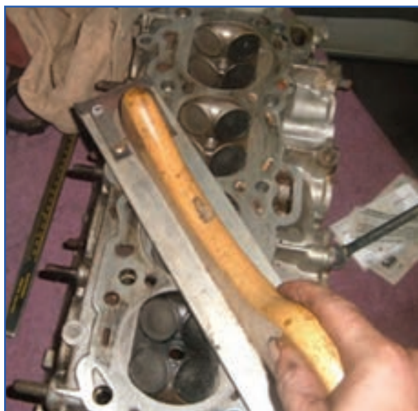
شکل ۴۴-۴- تمیز کردن سرسیلندر با سوهان نرم
