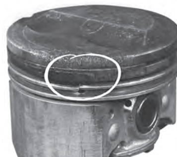
شکل ۴-۹۹- شکستن رینگ و تخریب جای رینگ
