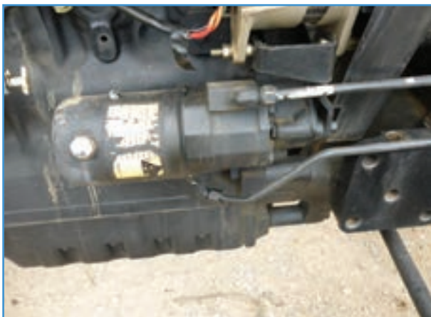
شکل ۲۳-۲. پمپ هیدرولیک فرمان و صافی تراکتور MF285
