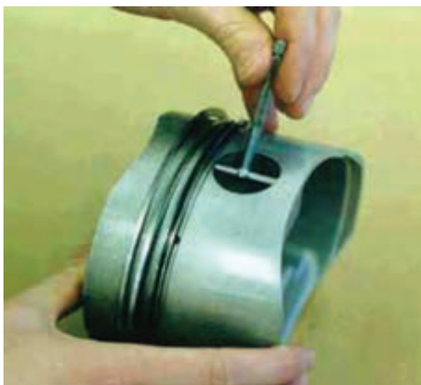
شکل ۱۱۷-۴ اندازه‌گیری سوراخ انگشتی روی پیستون
