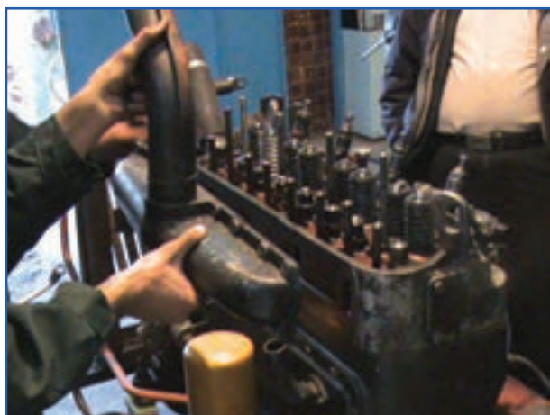
شکل ۴-۴- باز کردن مانیفلد هوا
