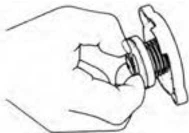
شکل ۱۷-۳- آزمون سوپاپ مکش در رادیاتور
