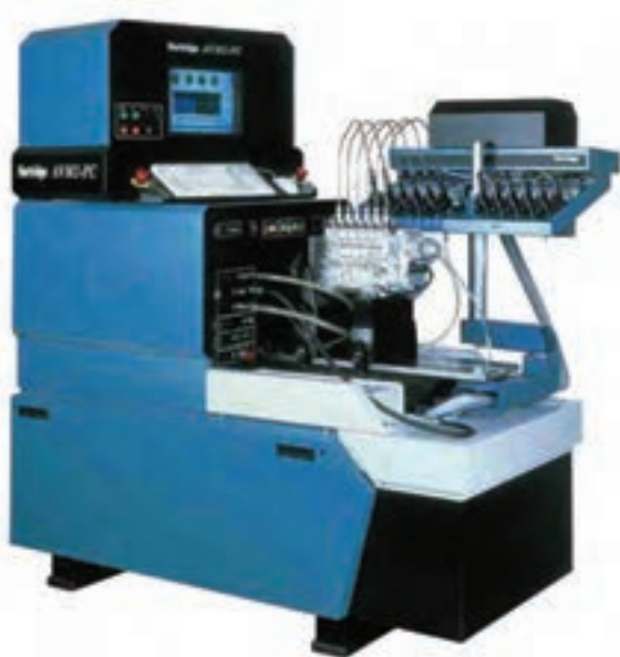
شکل ۲۴- دستگاه آزمودن و تنظیم پمپ انژکتور
