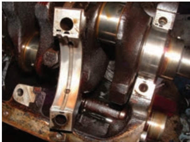
شکل ۱۸۲-۴ باز کردن کپه یاتاقان ثابت
