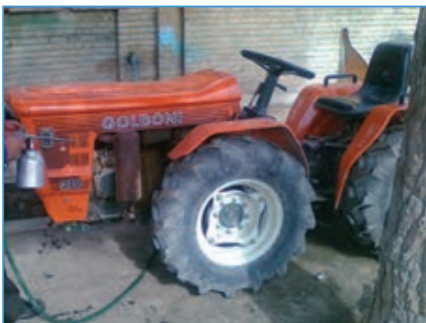
شکل ۱-۴- شستشوی موتور تراکتور با پیستوله شستشو
