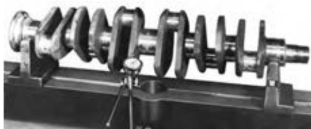
شکل ۱۶۰-۴ دستگاه اندازه‌گیری تاب میل‌لنگ
