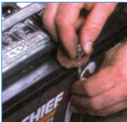
شکل ۹-۶ باز کردن بست نگهدارنده باتری
