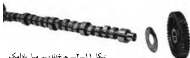
شکل ۱۱-۲ — چرخ‌دنده سر میل بادامک
