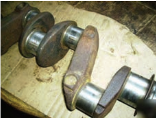
شکل ۴-۳۰- میل لنگ با رسوبات کربن
