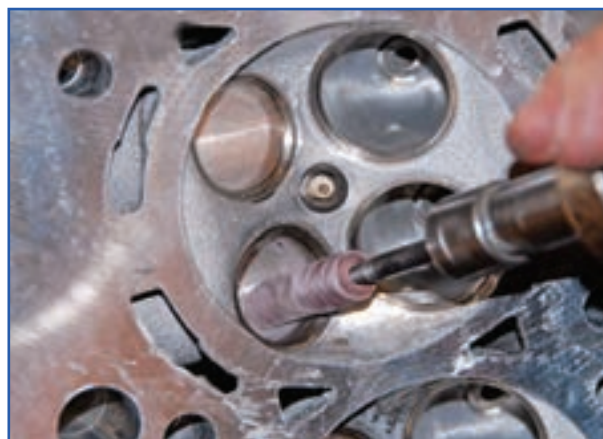
الف) نحوه تمیز کردن محفظه پشت سوپاپ
