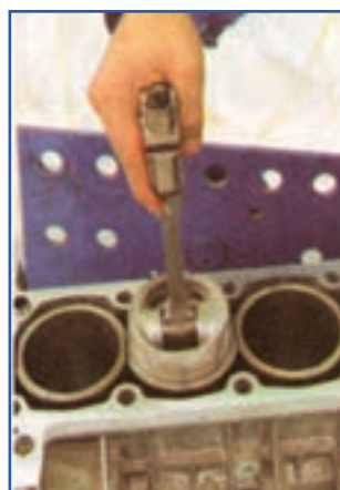
شکل ۱۲۷-۴ طرز قرار دادن رینگ داخل سیلندر
