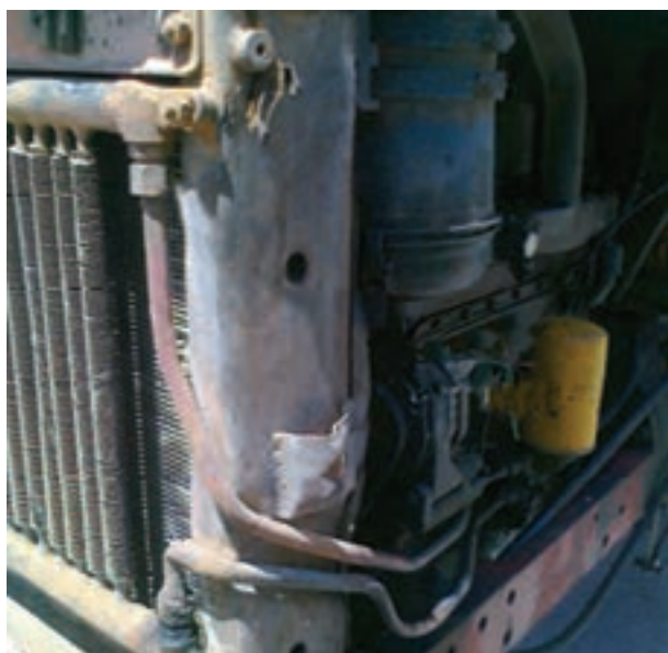
شکل ۱۲-۳ - محل مهره‌های رادیاتور روغن
