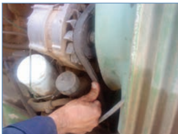
شکل ۳۶-۶ فشار دادن تسمه با شست
