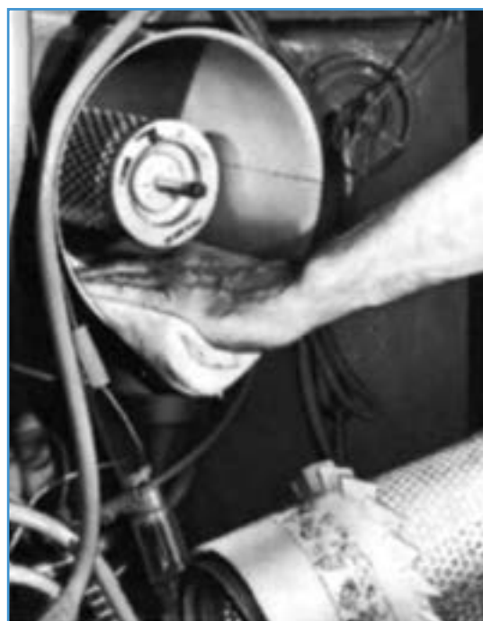
شکل ۵-۱۳ تمیز کردن بدنه صافی با پارچه
