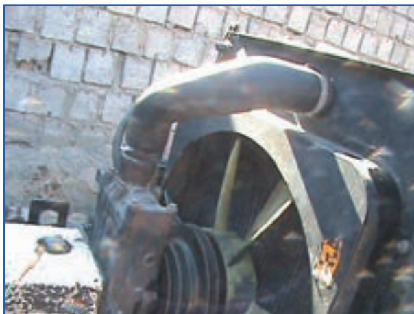
الف) باز کردن لوله لاستیکی رادیاتور
