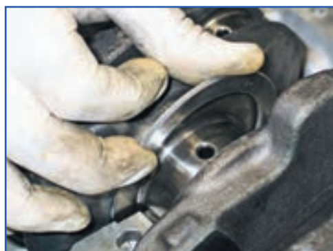
شکل ۱۸۴-۴ جازدن بغل یاتاقانی
