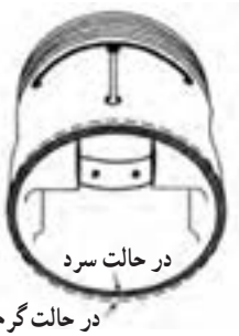
شکل ۱۹-۲ وضعیت پیستون در حالت گرم و سرد
