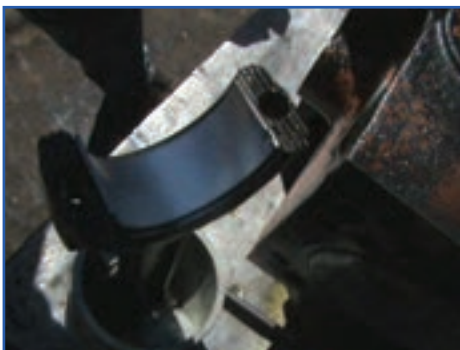
شکل ۱۹۳-۴ جا افتادن گودی یاتاقان‌ها در شیار مربوط به آن
