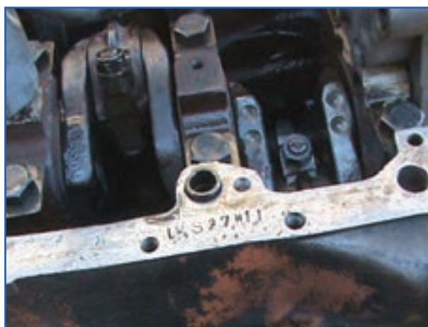
شکل ۸۲-۴- محفظه میل‌لنگ بدون پمپ روغن
