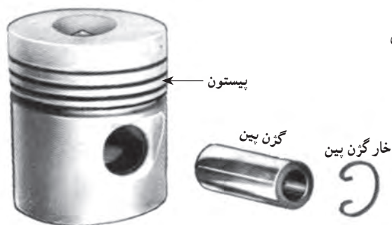
شکل ۳۰-۲- انگشتی و محل نصب آن روی پیستون
