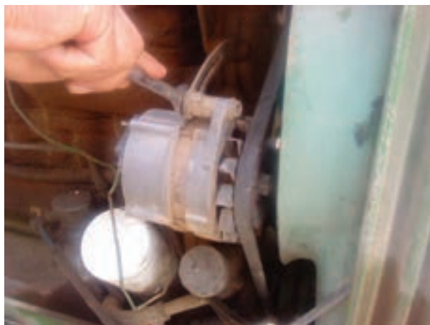
شکل ۳۸-۶ سفت کردن پیچ تنظیم آلترناتور
