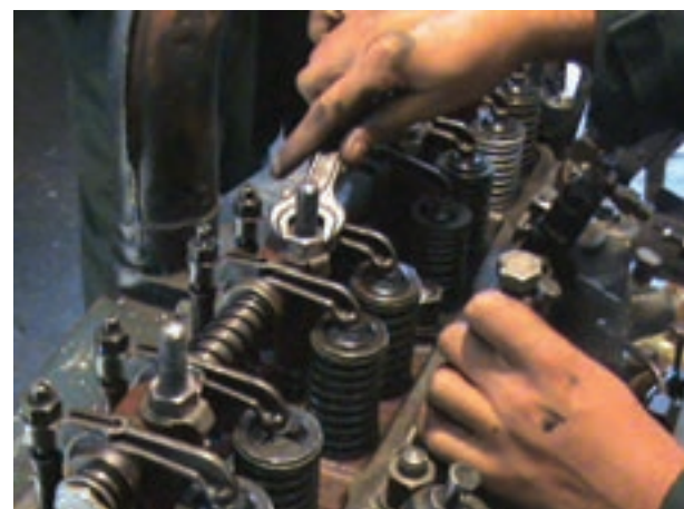
ب) باز کردن پایه محور اسبک MF399
