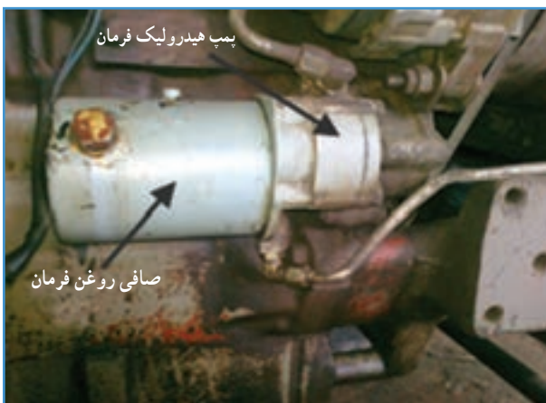
شکل ۲۳-۲. پمپ هیدرولیک فرمان و صافی تراکتور MF285
