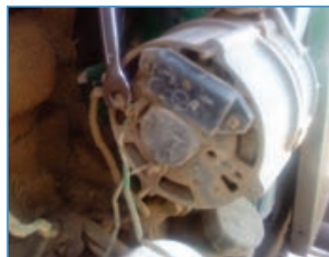
شکل ۳۳-۶ بستن سیم مثبت
