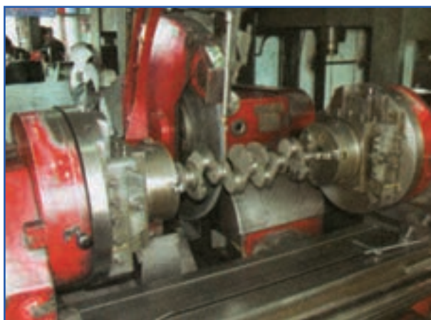
شکل ۱۶۴-۴ دستگاه میل لنگ تراشی
