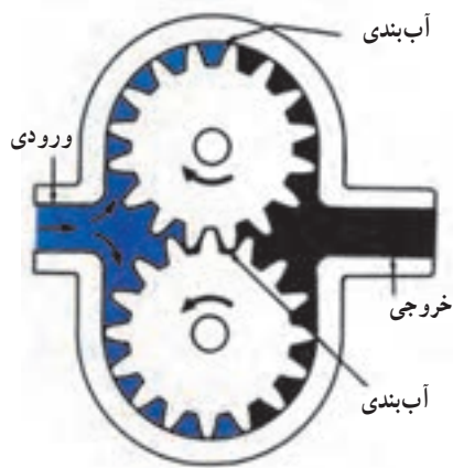
شکل ۱۹-۷- پمپ روغن چرخ دنده‌ای
