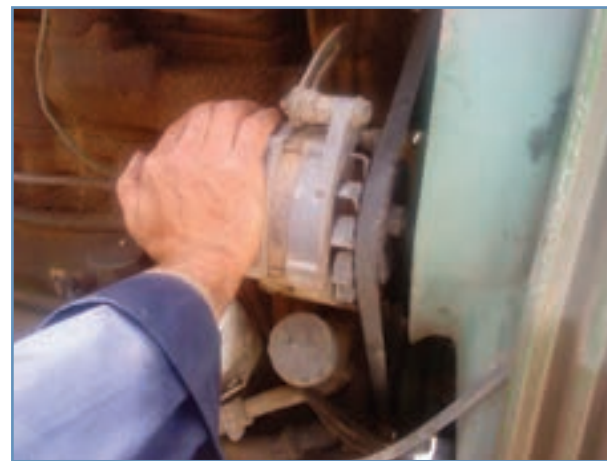
شکل ۳۰-۳ فشار دادن مولد به سمت موتور
