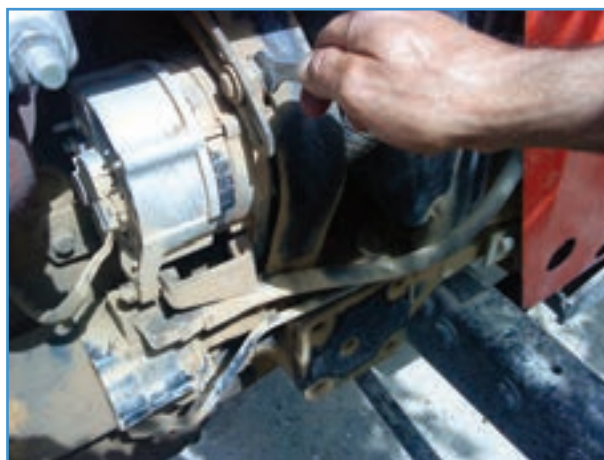
شکل ۲۹-۶ شل کردن پیچ و مهره تنظیم
