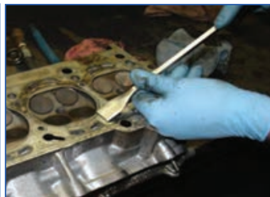
شکل ۴۲-۴- واشر سرسیلندر چسبیده به سیلندر
