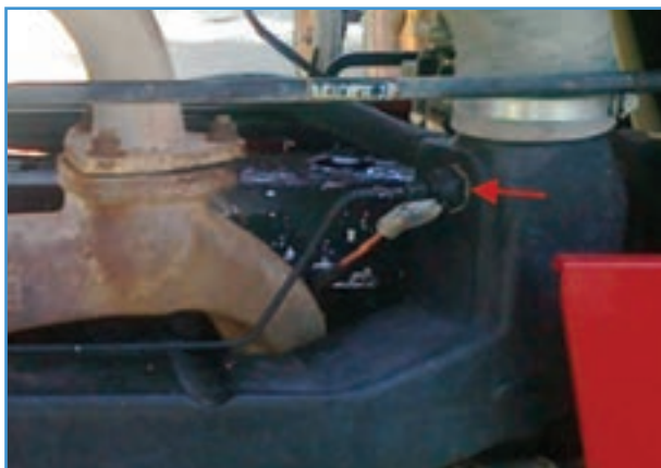
(ب) شمع گرم کن تراکتور MF399
