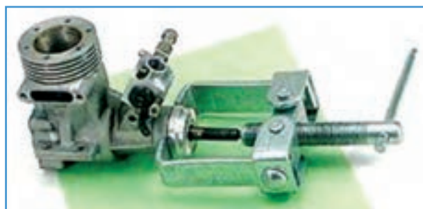
شکل ۷۷-۳- خارج کردن بلبرینگ با بلبرینگ کش
