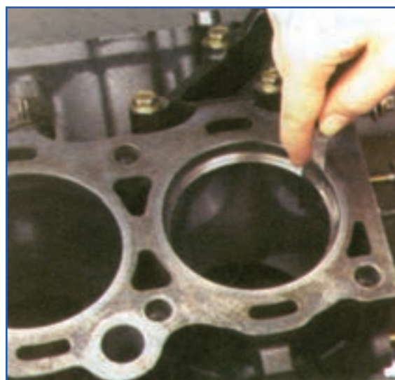
شکل ۱۲۸-۴- طرز اندازه گیری دهانه رینگ با فیلر
