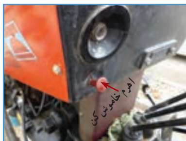
شکل ۱۳-۲ - اهرم خاموش کن تراکتور MF286
