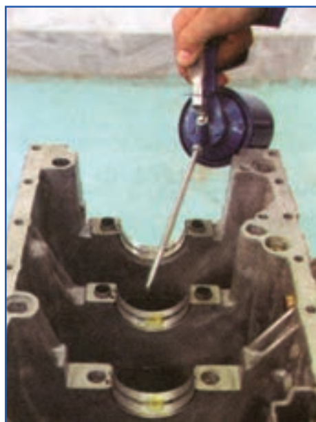
شکل ۱۸۷-۴ روغن کاری یاتاقان‌های ثابت
