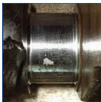
ب) پوسته کردن لایه سخت لنگ
