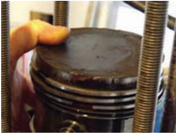
شکل ۴-۲۷- رسوبات کربن روی سطح پیستون
