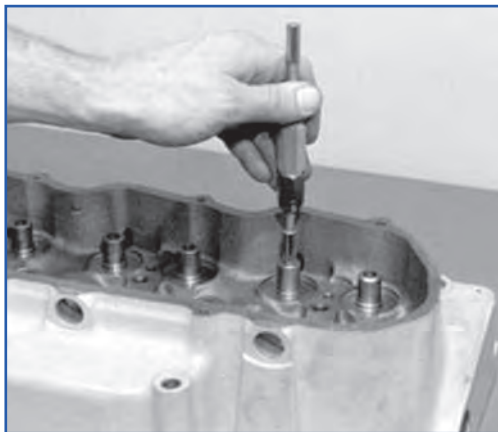
شکل ۴۰-۴- تمیز کردن گیت سوپاپ
