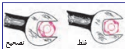
شکل ۲۹-۳ طرز درگیر کردن آچار تخت با مهره
