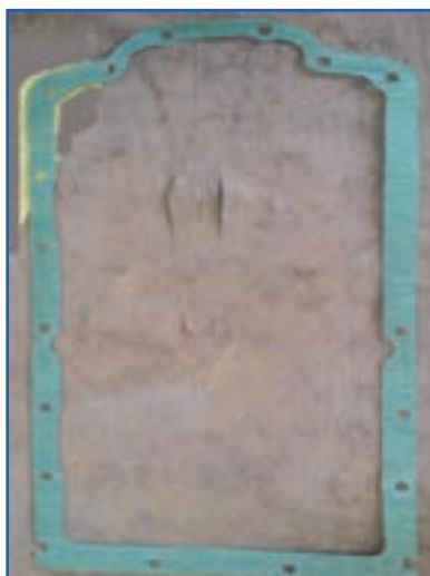
ب) واشر کارتر چوب‌پنبه‌ای MF285
