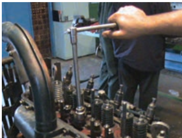
الف) باز کردن پیچ‌های سرسیلندر تراکتور U650
