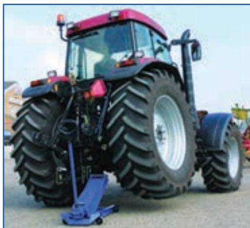
شکل ۱۳-۴ کاربرد جک سوسماری
