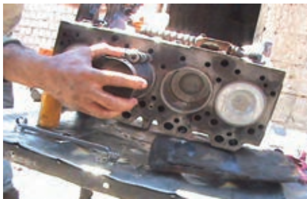
شکل ۱۹۹-۴- چسباندن رینگ جمع کن به سیلندر
