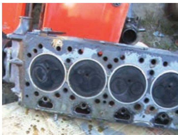
شکل ۱۵-۴ طرز قرار دادن سرسیلندر روی سطح صاف
