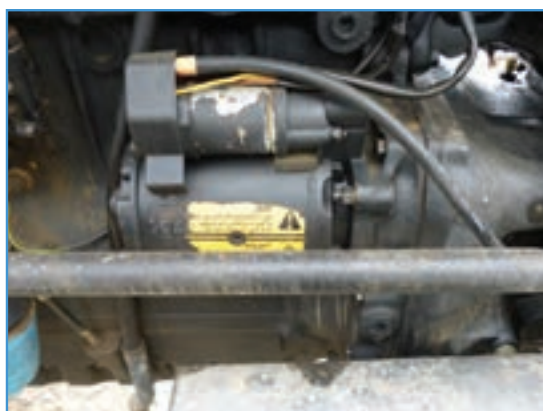
شکل ۲-۴۵ - استارت تراکتور MF285
