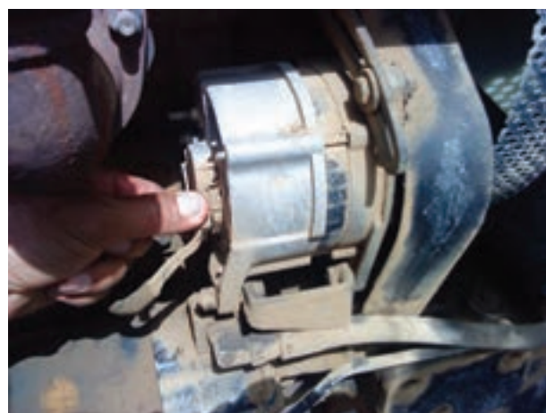
شکل ۲۸-۶- جدا کردن فیش از آلترناتور
