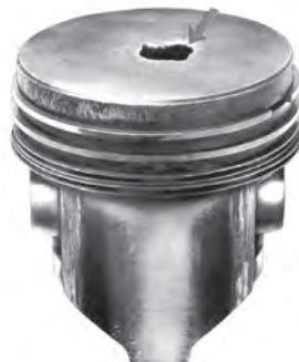
شکل ۴-۱۰۲- سوراخ شدن سر پیستون
