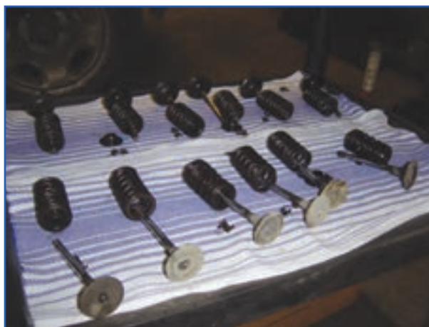
(الف) اجزای باز شده سوپاپ
