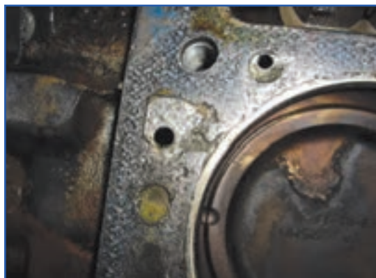
شکل ۴۲-۴- واشر سرسیلندر چسبیده به سیلندر
