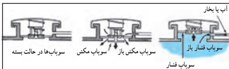
الف) وضعیت سوپاپ‌های در رادیاتور
