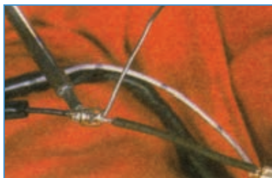
شکل ۶۴-۶- نحوه لحیم کاری سیم ها
