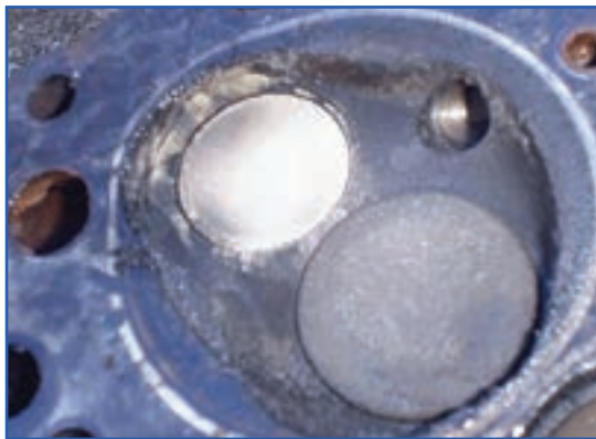
شکل ۴۱-۴- تمیز کردن اتاق احتراق
