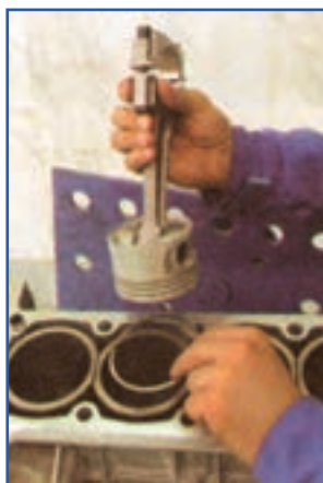
شکل ۱۲۷-۴ طرز قرار دادن رینگ داخل سیلندر
