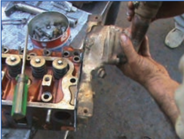
الف) باز کردن محفظه ترموستات تراکتور MF399
