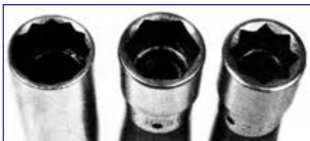
شکل ۳۵-۳- آچار بکس شش، هشت و دوازده گوش
