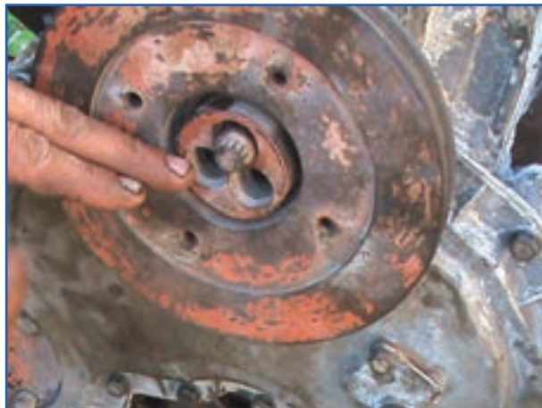
شکل ۴-۵۵- بستن پیچ سر میل لنگ تراکتور
