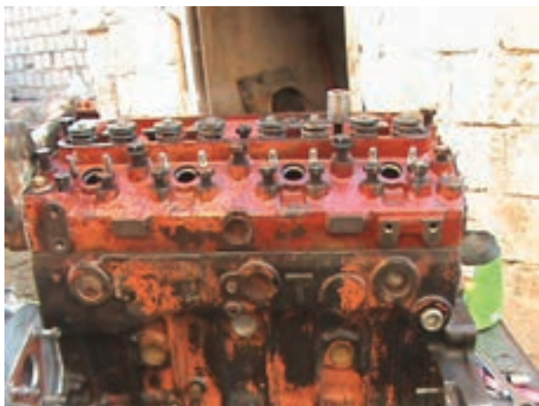
ب) پیچ‌های سرسیلندر باز شده تراکتور MF285
