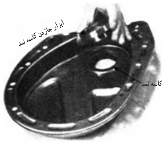
شکل ۴۳-۷- نحوه جازدن کاسه نمد روی سینی جلو
