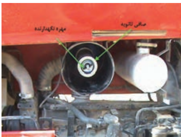
ب) محل قرار گرفتن صافی ثانویه
