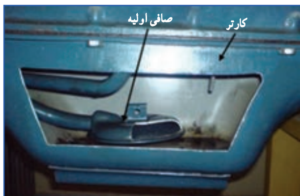
شکل ۲۴-۷- کارتیر برش خورده تراکتور U650
