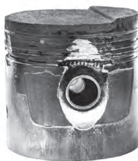
شکل ۴-۱۰۳- سایش غیریکنواخت پیستون
