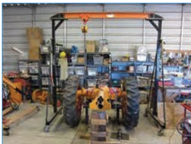
شکل ۲۴-۴ کاربرد جرثقیل دروازه‌ای متحرک
