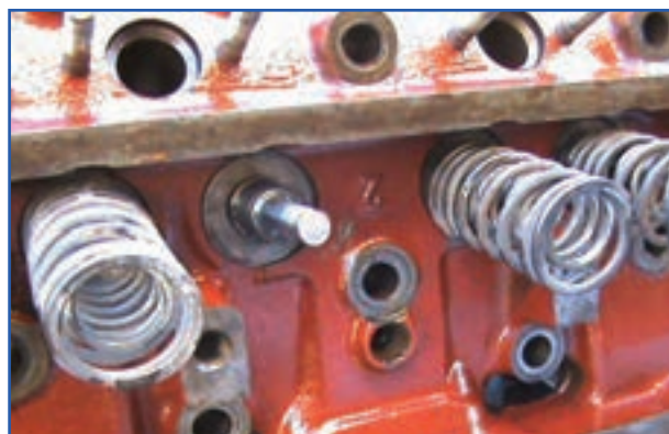
شکل ۴-۲۱- نحوه برداشتن فنر سوپاپ
