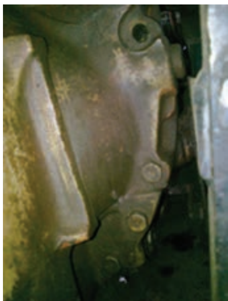
شکل ۱۱-۳ پیچ‌های اتصال موتور به جعبه‌دنده قسمت پایین
