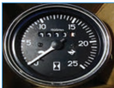
شکل ۱۲-۲ - سرعت سنج تراکتور
