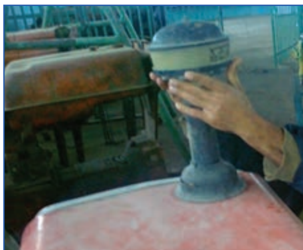
شکل ۲-۳- باز کردن پیش صافی
