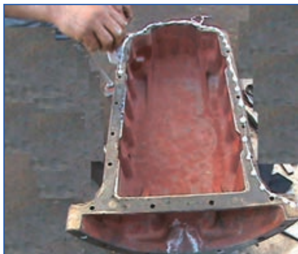
شکل ۳۲-۷ چسب زدن به محل قرارگیری واشر کارتر
