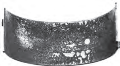
شکل ۱۶۸-۴ اثرات سوختگی روی یاتاقان
