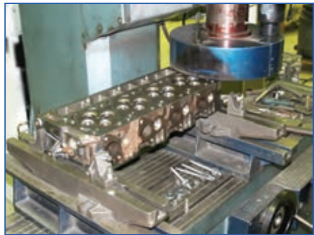
شکل ۳۲-۴- دستگاه کف تراشی سرسیلندر
