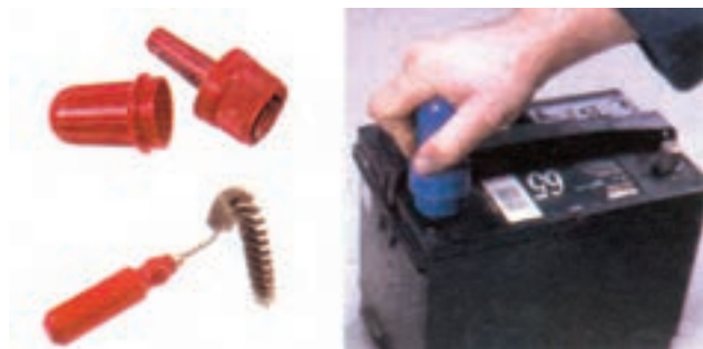
شکل ۲۳-۶- تمیز کردن قطب‌های باتری با ابزار مخصوص
