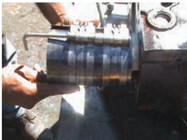
شکل ۱۹۸-۴- جمع کردن رینگ‌ها با رینگ جمع کن
