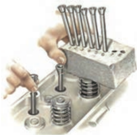
ب) به ترتیب قرار دادن میل تایپت
