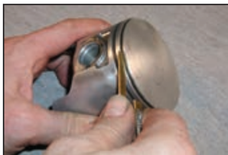
(د) تمیز کردن شیار با ابزار برنجی
