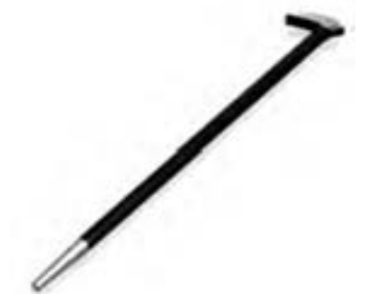
شکل ۳-۷۲- اهرم مخصوص خارج کردن انژکتور
