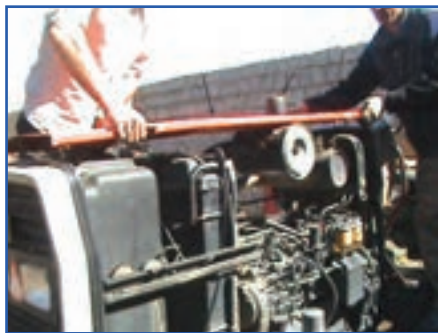
ج) برداشتن پوشش بالای موتور
