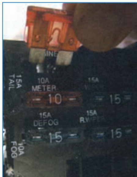
شکل ۶۹-۶- جازدن فیوز در محل آن
