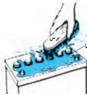
الف) تمیز کردن با برس و آب
