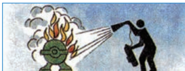
شکل ۱۴-۱- خاموش کردن آتش با دی اکسید کربن
