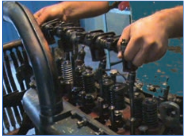
شکل ۹-۴ برداشتن محور اسبک و اسبک‌ها تراکتور U650
