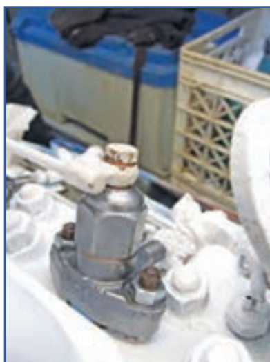
شکل ۵۴-۴- مراحل بستن انژکتور
