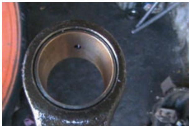
شکل ۱۲۰-۴ قرار گرفتن سوراخ بوش مقابل سوراخ شاتون
