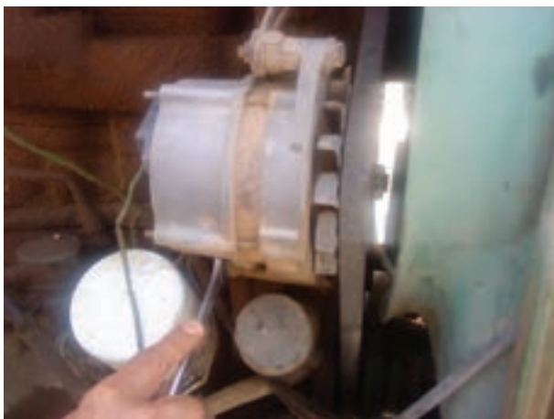
شکل ۳۹-۶ سفت کردن پیچ پایه
