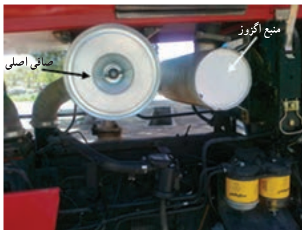
شکل ۲۶-۲ صافی اصلی تراکتور MF399
