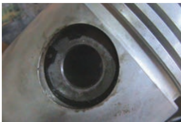
شکل ۱۲۵-۴ جا افتادن خار انگشتی در شیار پیستون
