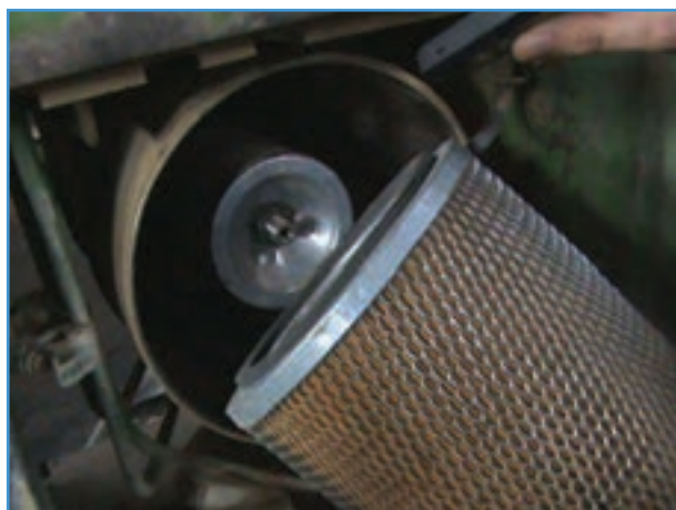
شکل ۵-۵ - صافی خشک و محل قرار گرفتن آن
