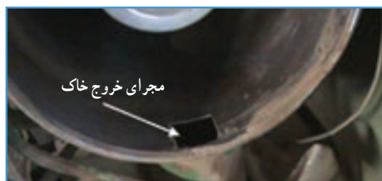
شکل ۵-۱۱ محل خاکدان در تراکتور جاندیر
