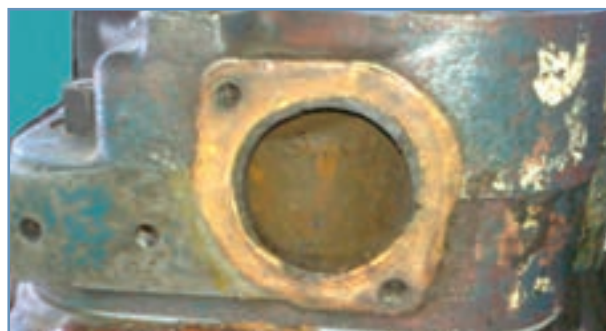
شکل ۲۳-۳ واشر ترموستات قبلی
