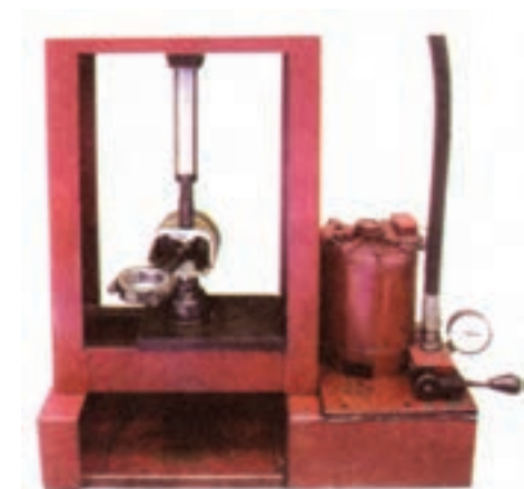
شکل ۸-۴- خارج کردن انگشتی با پرس هیدرولیک
