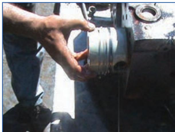
شکل ۱۹۷-۴- قرار دادن پیستون در سیلندر
