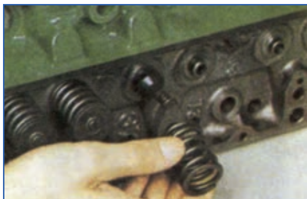
شکل ۴-۲۱- نحوه برداشتن فنر سوپاپ
