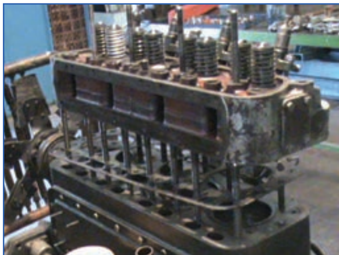
شکل ۲-۵- وضعیت قرار گرفتن واشر سرسیلندر
