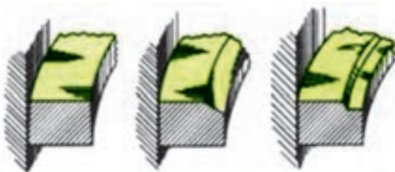
شکل ۱۳۲-۴ فرم خاص در لبه داخلی رینگ
