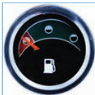
شکل ۹-۲- درجه نشان‌دهنده مقدار سوخت در مخزن سوخت
