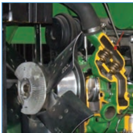
شکل ۲۴-۳ طرز صحیح قرار گرفتن ترموستات
