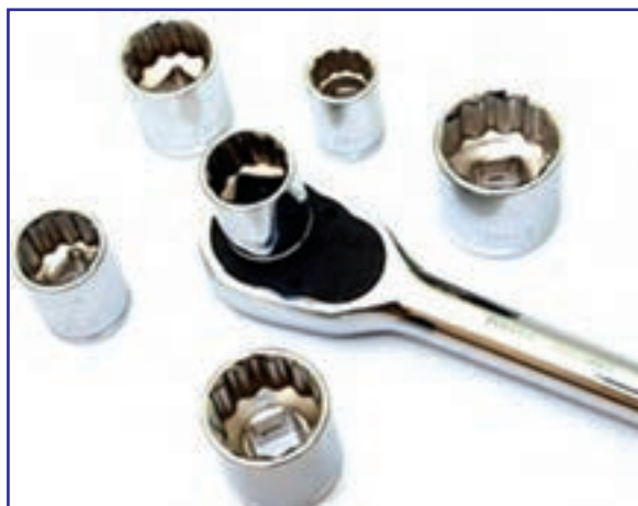
شکل ۴۸-۳ اتصال بکس به دسته بکس جفجغه ای
