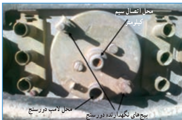
شکل ۸۲-۶- دورسنگ از قسمت پشت داشبورد تراکتور U650M
