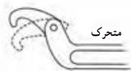
شکل ۵۹-۳ نحوه استفاده از آچار مهره‌ای گرد
