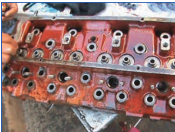
(ب) نحوه خارج کردن لاستیک آب بندي
