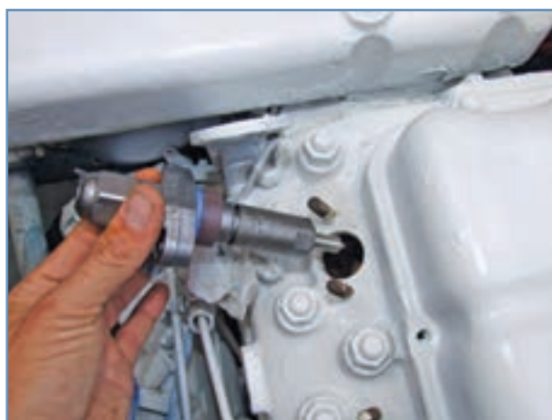
شکل ۲۳-۴ خارج کردن انژکتور
