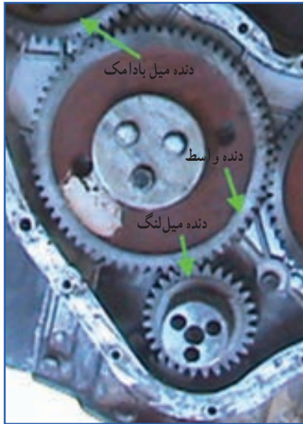
شکل ۱۲-۲- نسبت دنده میل بادامک به میل لنگ
