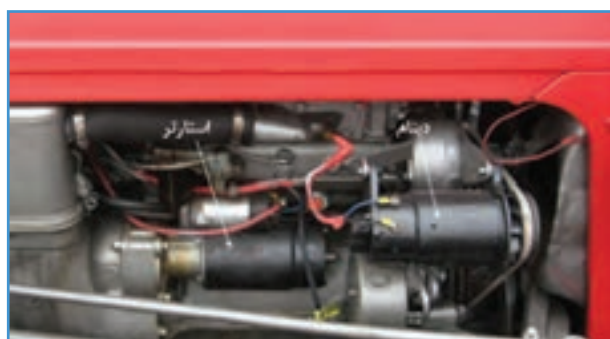
شکل ۲۷-۶- مولد روی تراکتور
