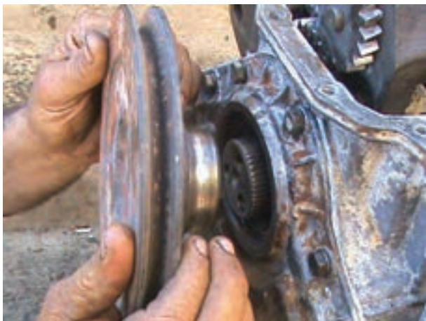
شکل ۴-۵۷- خارج کردن پولی میل لنگ
