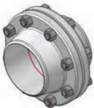
شکل ۳-۱- کاربرد پیچ و مهره برای اتصال
