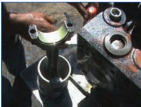
شکل ۱۹۲-۴ روغن‌کاری رینگ‌ها، پیستون و یاتاقان
