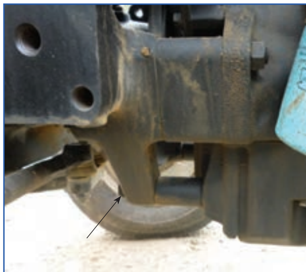
شکل ۱۷-۳- محل پیچ‌های اتصال موتور به جلوی تراکتور
