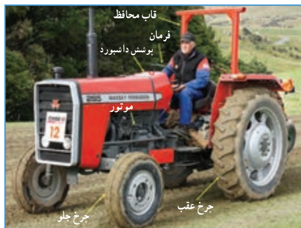
شکل ۱-۲- قطعات ظاهری تراکتور
