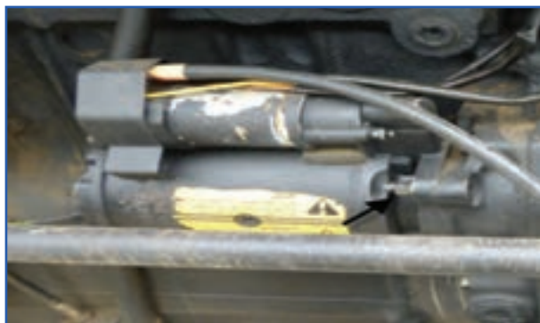
شکل ۳-۸ پیچ های نگه دارنده استارت تر تراکتور MF285
