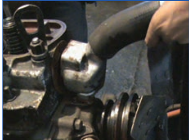
ب) باز کردن محفظه ترموستات تراکتور U650
