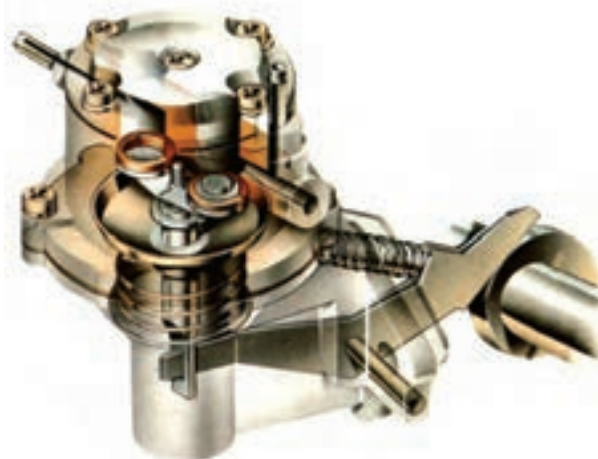
شکل ۷-۴ پمپ مقدماتی دیافراگمی
