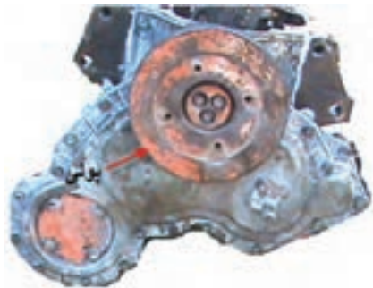
شکل ۴-۶۴- پولی نصب‌شده روی میل‌لنگ
