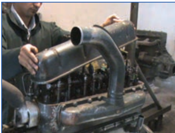
شکل ۴۰-۷ برداشتن قالباق سوپاپ
