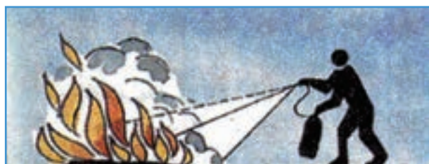
شکل ۱۳-۱- روش خاموش کردن آتش با پودر
