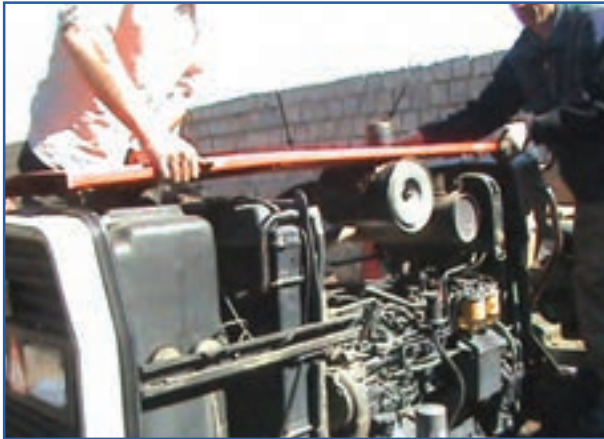
شکل ۱-۴- برداشتن کاپوت از روی موتور
