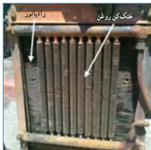
الف) خنک کن روغن تراکتور U650
