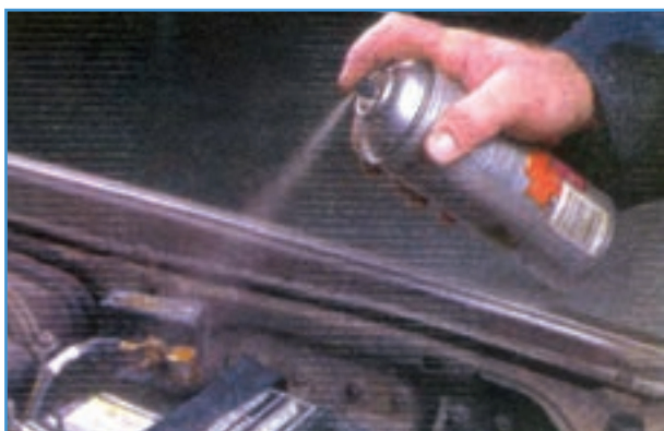
شکل ۱۱-۶ پاشیدن اسپری ضد خوردگی روی بست باتری
