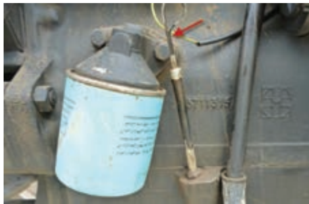
شکل ۳۰-۷ میله سنجش سطح روغن تراکتور MF285
