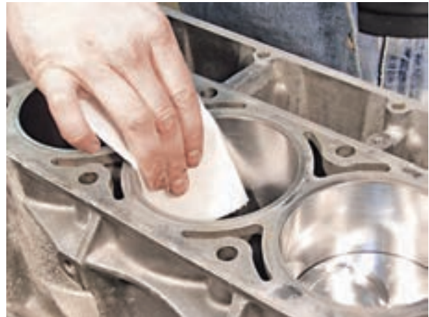
شکل ۴-۲۸- تمیز کردن داخل سیلندر
