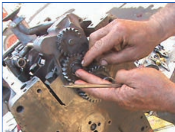
شکل ۷۹-۴- خارج کردن چرخ‌دنده پمپ روغن
