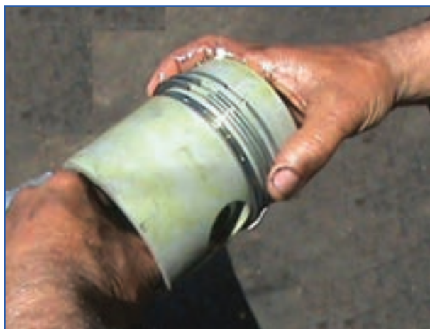
شکل ۱۹۶-۴- تنظیم کردن دهانه رینگ‌ها
