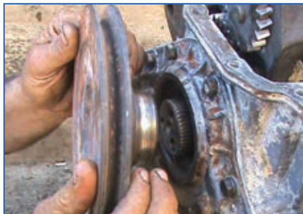
شکل ۴۶-۷- جازدن چرخ تسمه سر میل لنگ
