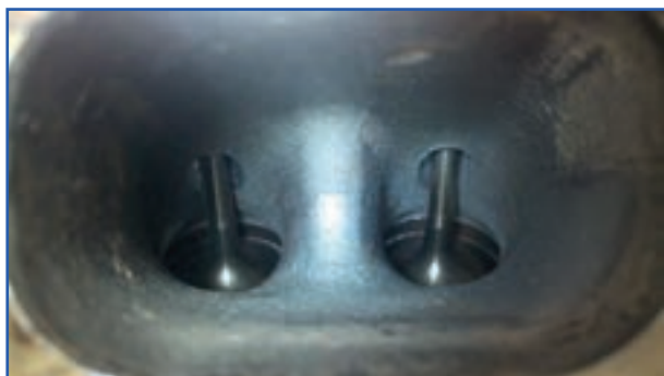
ب) محفظه تمیز پشت سوپاپ‌ها
