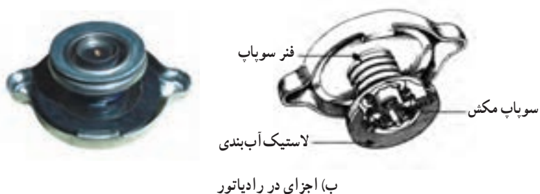
شکل ۳-۵- در رادیاتور و طرز کار سوپاپ‌های آن
