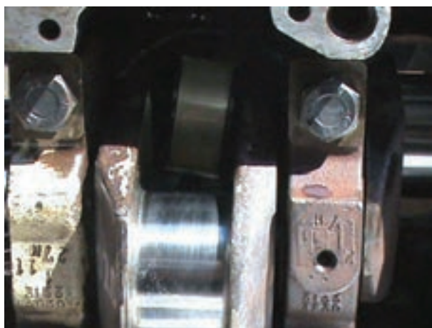
شکل ۸۸-۴ شاتون در حال خارج شدن
