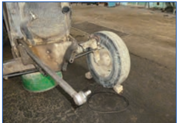
شکل ۱۹-۳ قسمت جلوی تراکتور جدا شده از موتور
