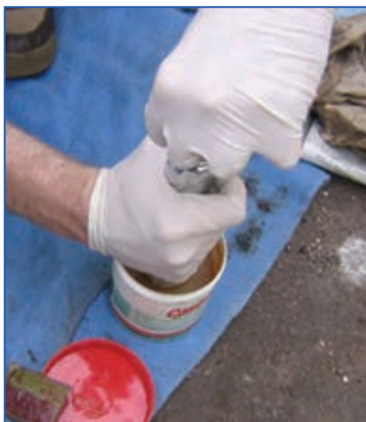
شکل ۴۸- ۷- مراحل پر کردن گریس پمپ دستی
