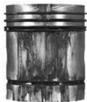
الف) خط و خش روی پیستون
