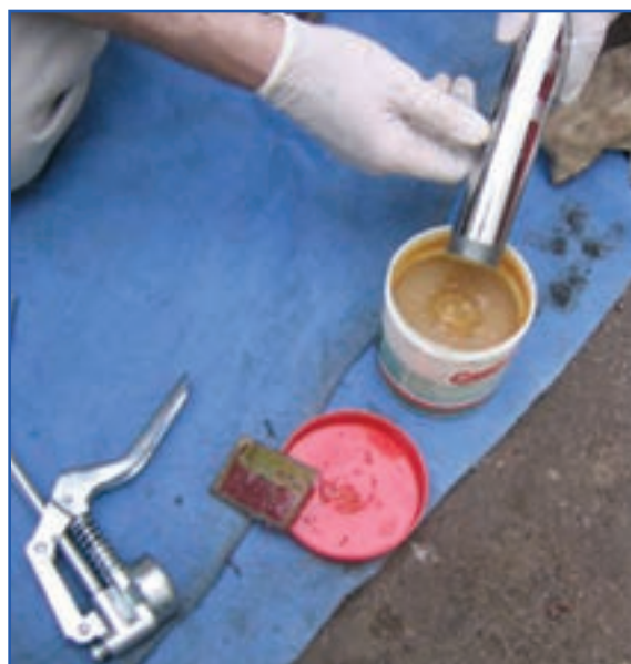
شکل ۴۸- ۷- مراحل پر کردن گریس پمپ دستی
