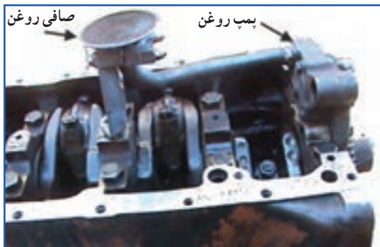
الف) محفظه میل‌لنگ بدون کارتر
