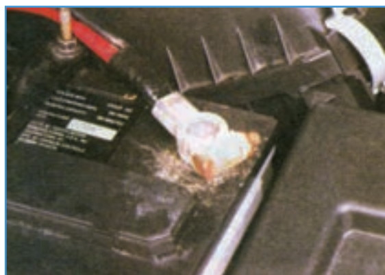
شکل ۲۱-۶- سولفاته کردن بست مثبت باتری
