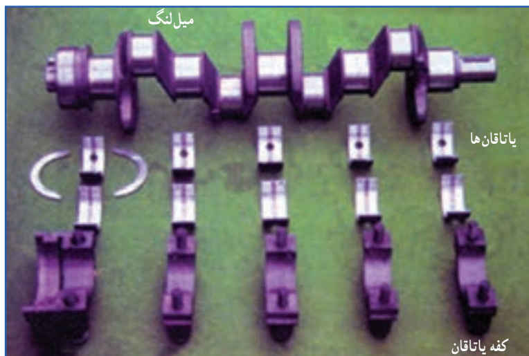
شکل ۳۹-۲ میل لنگ، یاتاقان ها و کفه یاتاقان های ثابت
