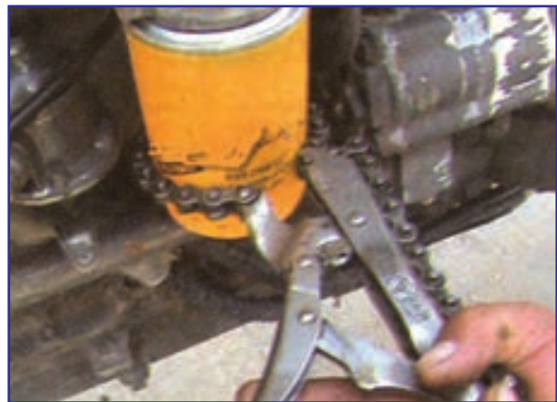
شکل ۱۶-۷ باز کردن صافی روغن با آچار مخصوص
