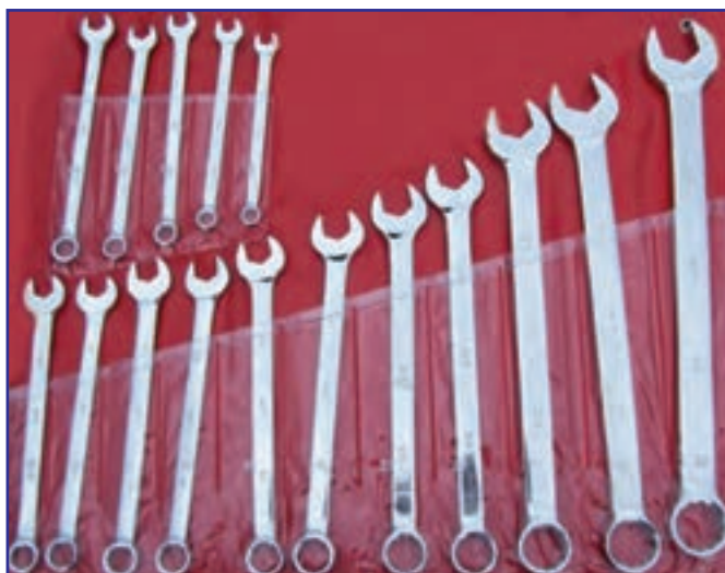
شکل ۳۳-۳- یک سری آچار یک سر رینگ
