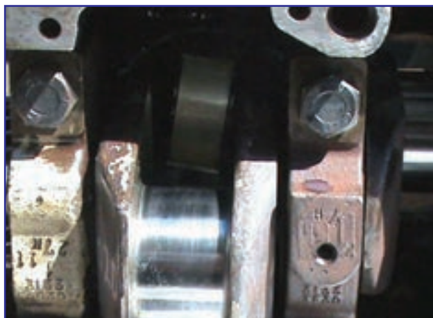
شکل ۲۰۱-۴ هدایت شاتون روی میل لنگ
