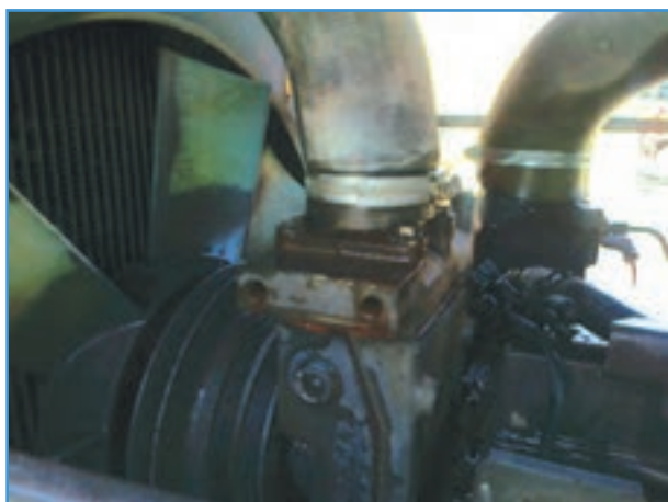
شکل ۱۱-۳ - محل بست شیلنگ محفظه ترموستات
