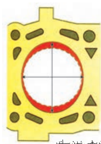
شکل ۱۴۹-۴ وضعیت بیضی شدن سیلندر
