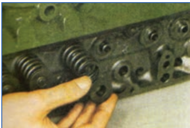
شکل ۴-۲۰- نحوه برداشتن بشقابک فنر سوپاپ
