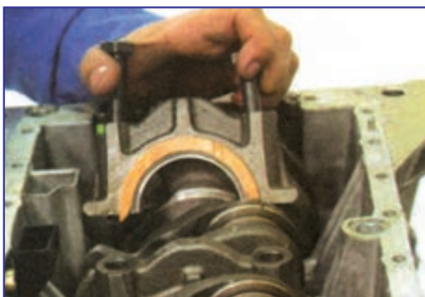
شکل ۱۸۱-۴ برداشتن کپه یاتاقان دارای بغل یاتاقانی
