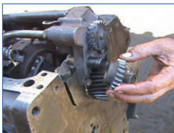
شکل ۸۰-۴- خارج کردن چرخ‌دنده پمپ روغن
