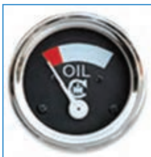
شکل ۸-۲- درجه نشان‌دهنده فشار روغن
