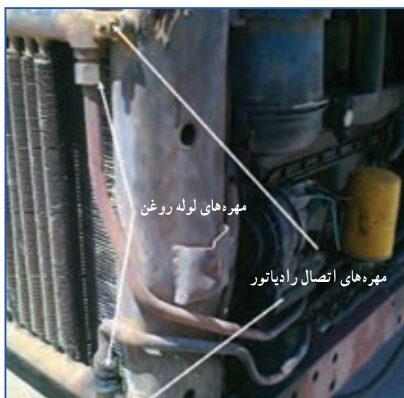
شکل ۳۸- ۷- مهره های لوله روغن سمت رادیاتور روغن
