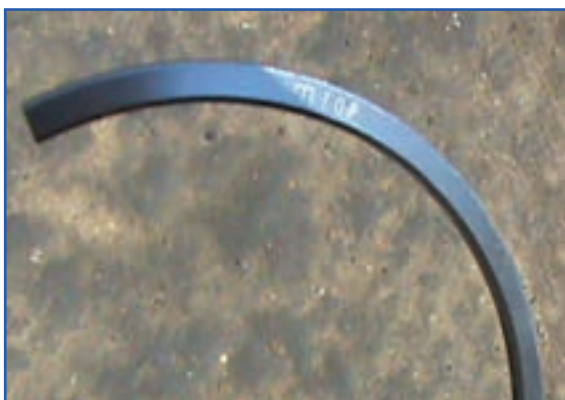
شکل ۱۳۴-۴ علامت TOP روی رینگ
