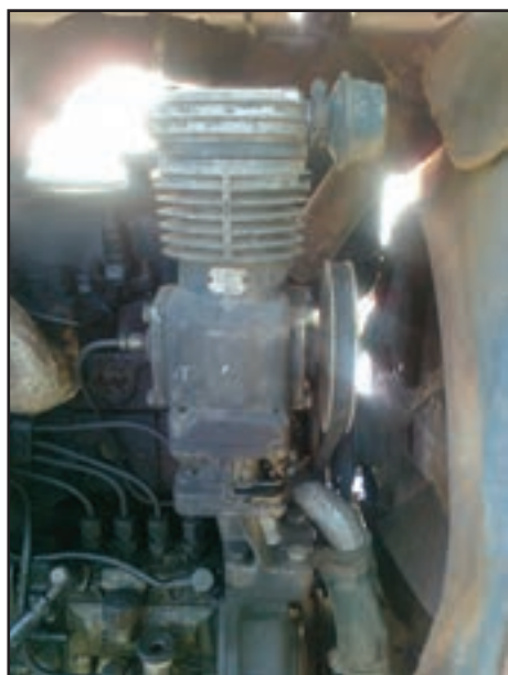
شکل ۸-۲- محل قرار گرفتن پمپ باد در تراکتور U650
