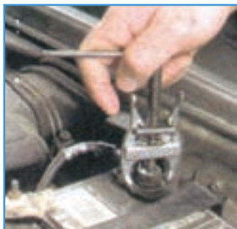
شکل ۶-۷ جدا کردن بست منفی باتری
