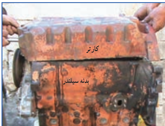
ب) برداشتن کارتر
