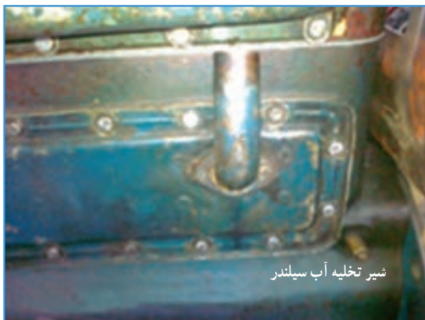
شکل ۸-۳ شیر تخلیه آب سیلندر تراکتور U650
