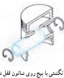
شکل ۳۱-۲- انواع اتصال انگشتی به پیستون
