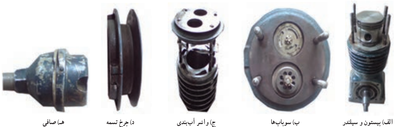
شکل ۳-۸- اجزای کمپرسور باد
