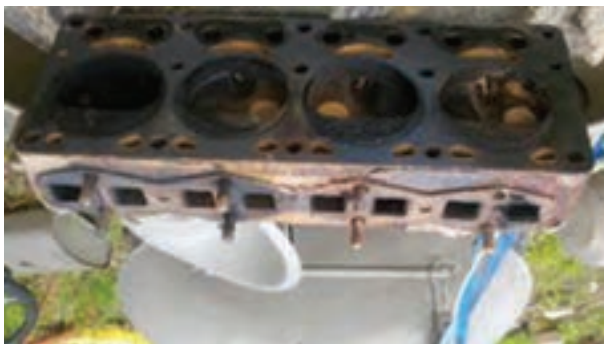
شکل ۴-۲۹- رسوبات کربن سطح سرسیلندر
