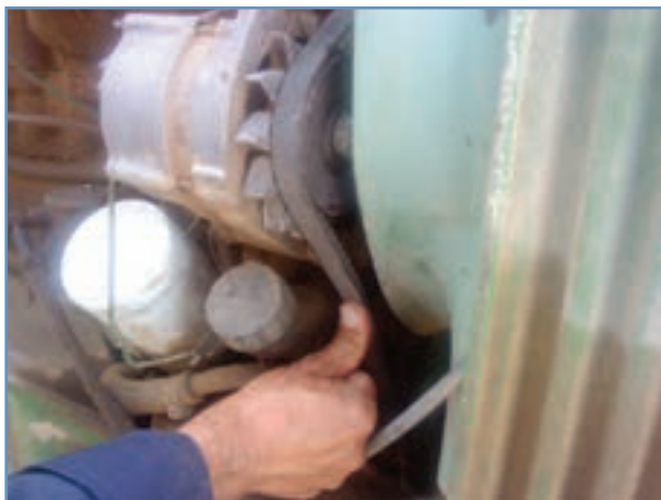
شکل ۲۸-۳ اندازه‌گیری کشش تسمه با فشار انگشت
