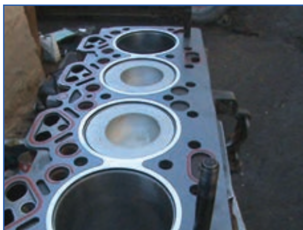
شکل ۵۲-۴- قرار دادن واشر سرسیلندر روی بدنه سیلندر
