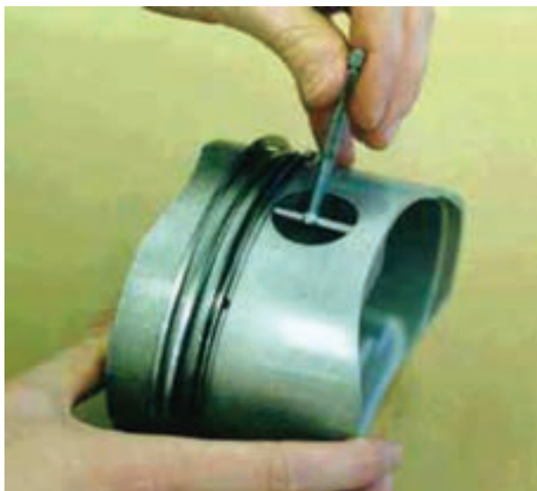
شکل ۱۱۷-۴ اندازه‌گیری سوراخ انگشتی روی پیستون
