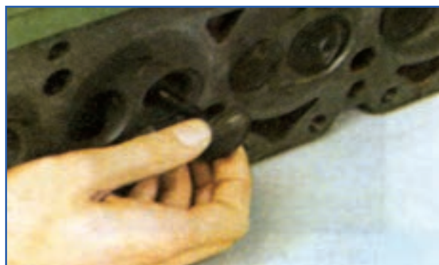
شكل ۲۳-۴- نحوه خارج کردن سوپاپ‌ها
