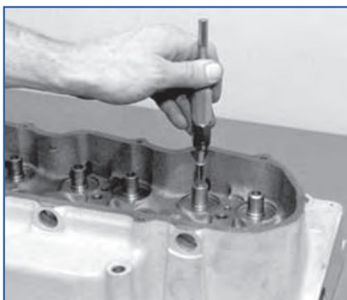
شکل ۴۰-۴- تمیز کردن گیت سوپاپ
