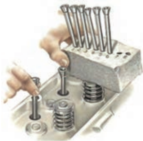
ب) به ترتیب قرار دادن میل تایپت
