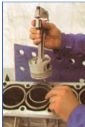
شکل ۱۲۷-۴ طرز قرار دادن رینگ داخل سیلندر
