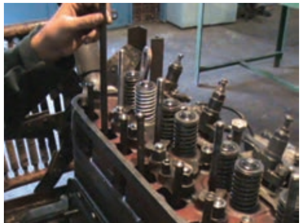
الف) برداشتن میل تایپت
