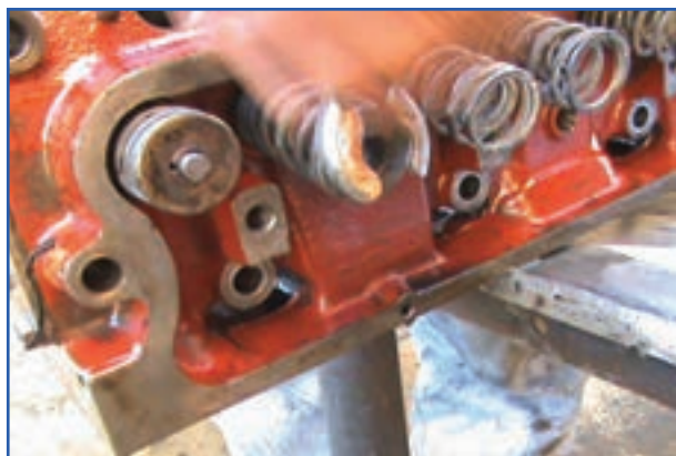
شکل ۴-۱۹- باز کردن اهرم فنر جمع کن
