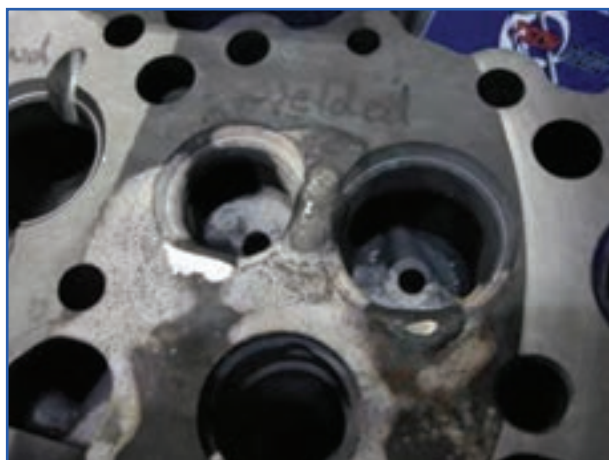
شکل ۲۶-۴- ترمیم ترک سرسیلندر با جوشکاری
