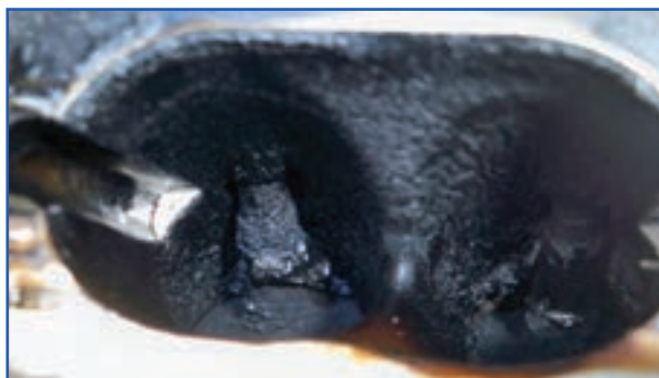
الف) کربن محفظه پشت سوپاپ‌ها
