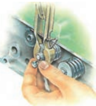
شکل ۴-۱۸- نحوه خارج کردن خار سوپاپ
