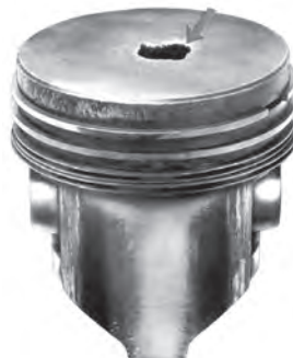
شکل ۴-۱۰۲- سوراخ شدن سر پیستون
