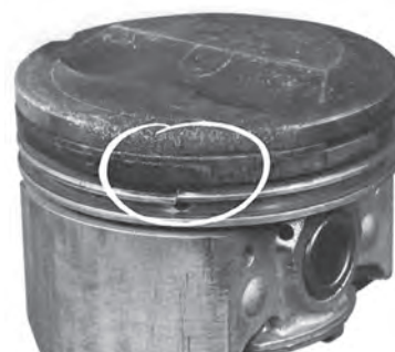
شکل ۴-۹۹- شکستن رینگ و تخریب جای رینگ
