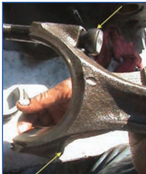
شکل ۸۵-۴- خارج کردن پیچ شاتون
