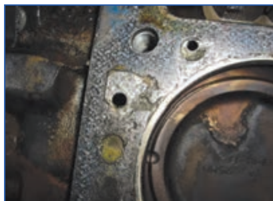
(ب) واشر سرسیلندر چسبیده سرسیلندر
