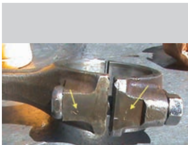
شکل ۸۷-۴ علامت روی کپه شاتون و شاتون
