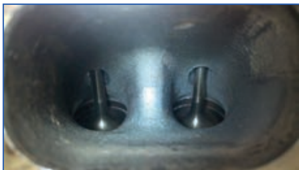
ب) محفظه تمیز پشت سوپاپ‌ها
