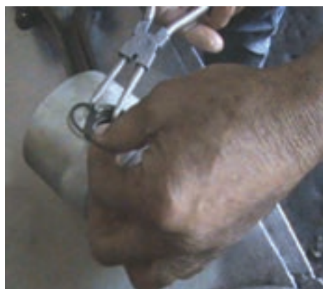
شکل ۱۲۵-۴ طرز جازدن خار انگشتی
