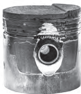
شکل ۴-۱۰۳- سایش غیریکنواخت پیستون
