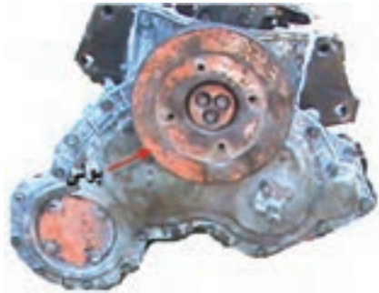
شکل ۴-۶۴ - پولی نصب‌شده روی میل‌لنگ
