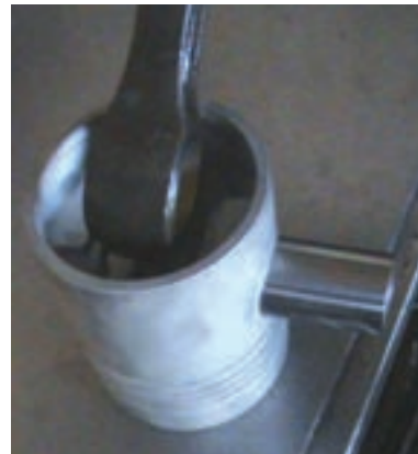
شکل ۱۲۲-۴ اتصال شاتون به پیستون و جازدن انگشتی
