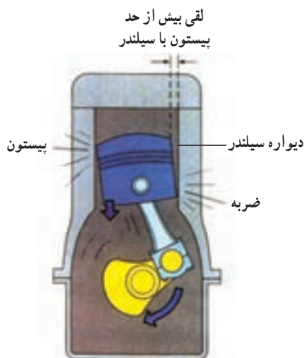
شکل ۱۰۶-۴ برخورد لبه‌های پیستون به سیلندر
