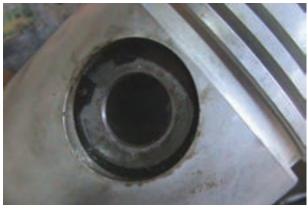
شکل ۱۲۵-۴ جا افتادن خار انگشتی در شیار پیستون
