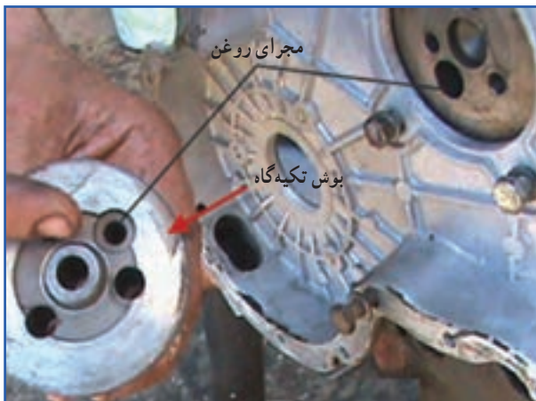
شکل ۶۸-۴ خارج کردن بوش تکیه‌گاه چرخ‌دنده واسط
