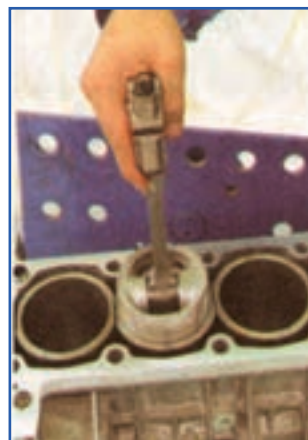
شکل ۱۲۷-۴ طرز قرار دادن رینگ داخل سیلندر
