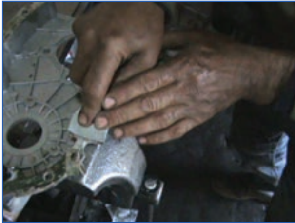
شکل ۷۶-۴- تمیز کردن واشر محفظه جلو موتور
