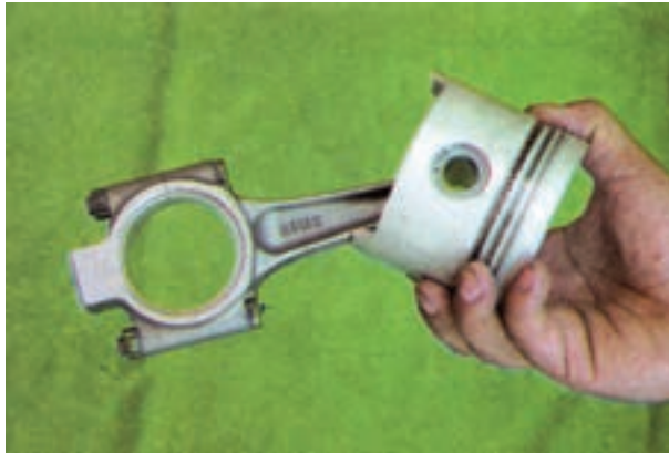
شکل ۱۲۶-۴ طرز آزمایش لقی شاتون روی انگشتی
