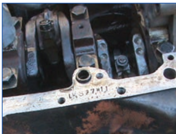
شکل ۸۲-۴- محفظه میل‌لنگ بدون پمپ روغن
