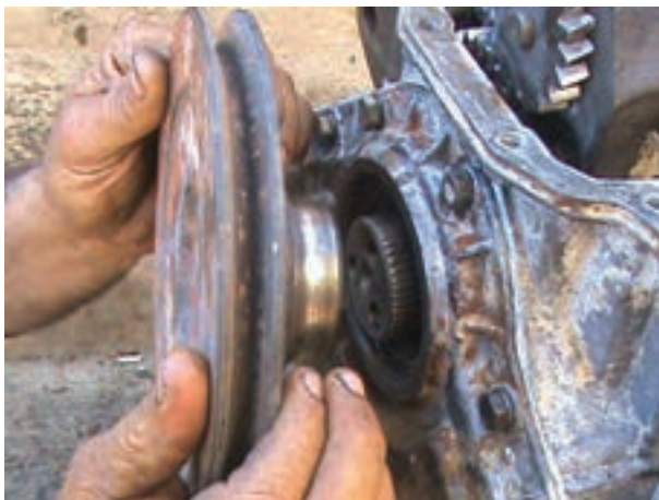
شکل ۴-۵۷- خارج کردن پولی میل لنگ
