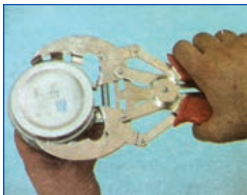
ب) طرز باز کردن و خارج کردن رینگ
