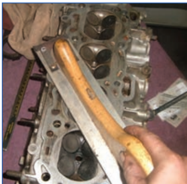
شکل ۴۴-۴- تمیز کردن سرسیلندر با سوهان نرم
