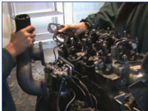
شکل ۴-۴- باز کردن مانیفولد هوا
