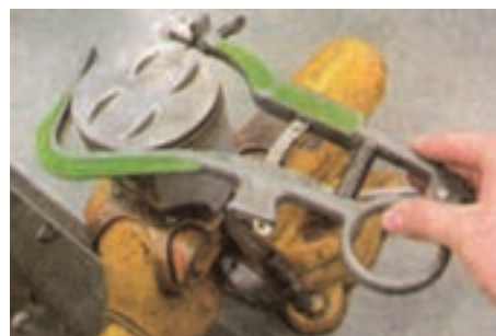
(ب) کاربرد ابزار تمیزکننده شیار رینگ‌ها
