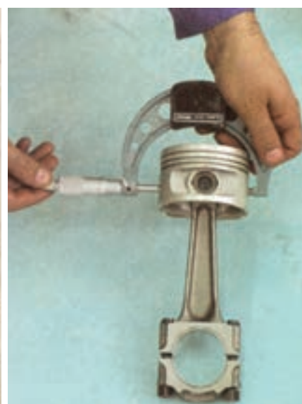
(الف) اندازه گیری قطر دامن پیستون
