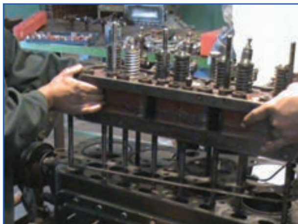
شکل ۱۴-۴ بلند کردن سرسیلندر از روی بدنه سیلندر
