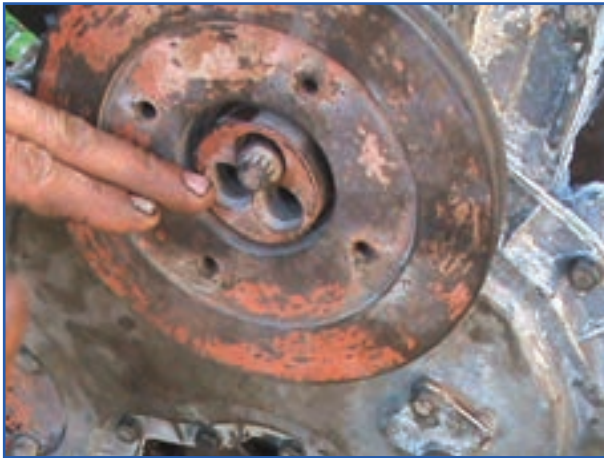
شکل ۴-۵۵- بستن پیچ سر میل لنگ تراکتور
