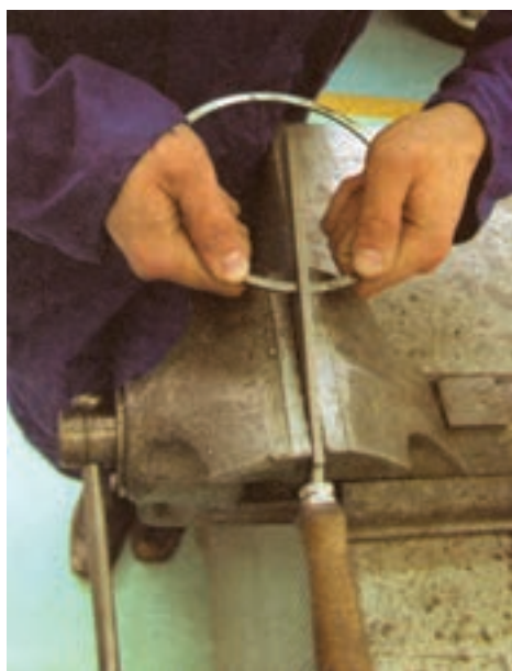
شکل ۱۳۰-۴ ساییدن دهانه رینگ با سوهان
