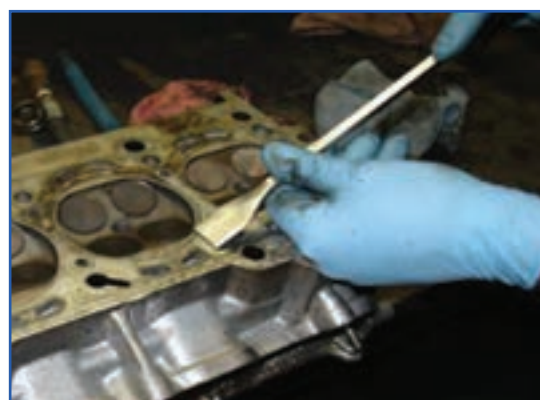
(الف) نحوه تمیز کردن واشر سرسیلندر با کاردک
