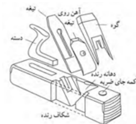
شکل ۶-۱۳- قسمت‌های مختلف اجزای رنده پوبی و نمونه‌ی جاگذاری آنها.
