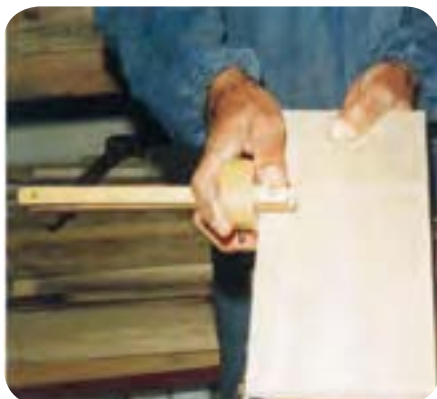
شکل ۶-۷۷. فطاکشی روی چوب با فطاکش تیره‌دار.
