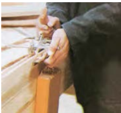
شکل ۶-۸۲- چگونگی کار با رنده کنشکاف.
