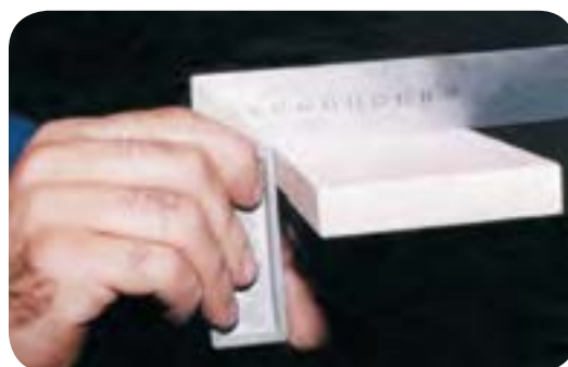
شکل ۶-۷۴. آزمایش صمت رنده‌کاری با گونیا
