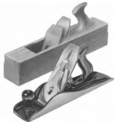
شکل ۶-۵۴- نمونه‌هایی از رنده چوبی و فلزی.
