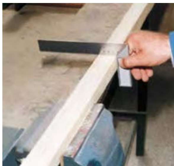
شکل ۶-۸۵- صحت گونیایی بودن قطعه کار با گونیا.
