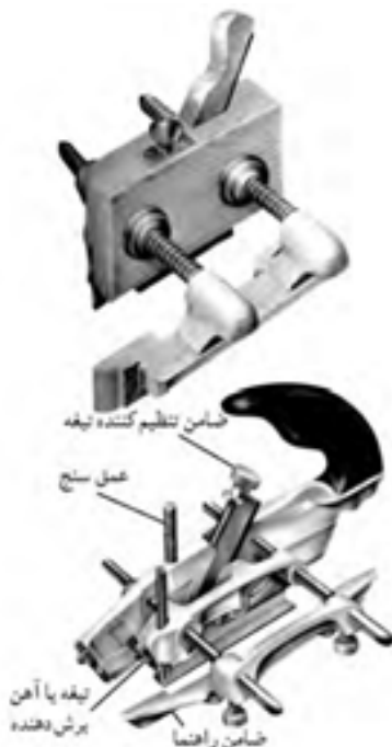
شکل ۶-۳۹- قسمت‌های مختلف رنده کنشکاف.
