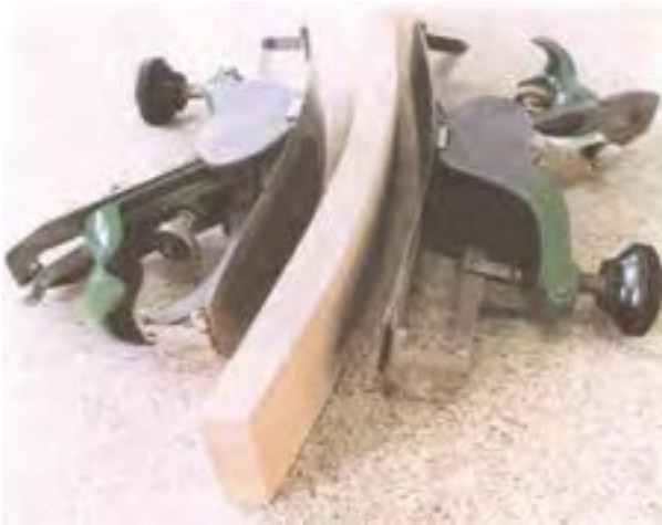
شکل ۶-۴۷- رنده کاس و سینه در حالت ممدب و مقعر.
