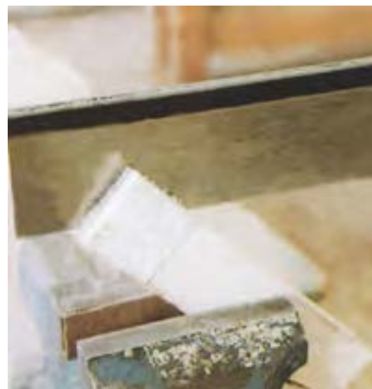
شکل ۵-۵۵. مالت افقی ارّه در پایان برش.
