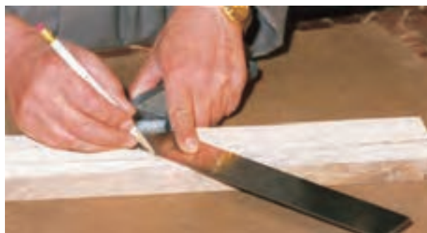
شکل ۶-۹۳- کار کردن با گونیای فارسی.
