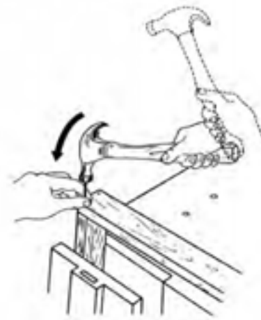
شکل ۷-۲۸- ضربه زدن در راستای محور میخ.
