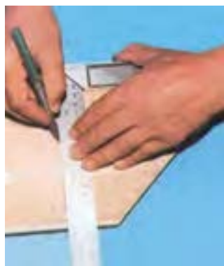
شکل ۶-۱۰۳- استفاده از گونیا برای خط‌کشی.
