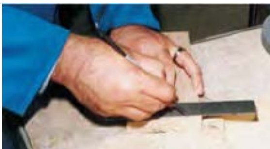
شکل ۶-۸۶- خط‌کشی با استفاده از گونیا.
