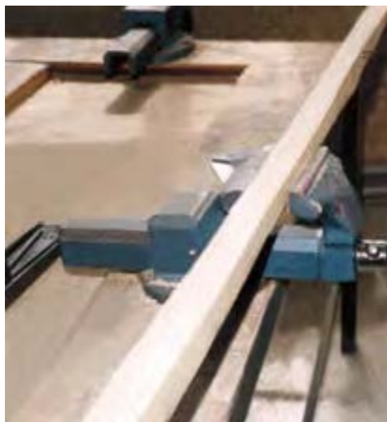
شکل ۶-۸۳- بستن قطعه کار به گیره میز کار.
