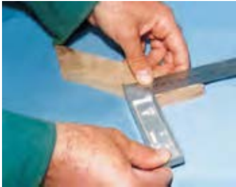
شکل ۵-۶۵- کنترل گونیایی بودن قطعه کار.
