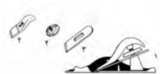
شکل ۶-۶۱- قسمت‌های تفکیک شده رنده کله چوب شامل:
