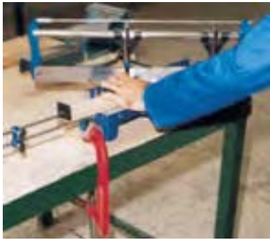
شکل ۵-۶۴- ایجاد برش ۴۵ درجه به وسیله‌ی ارّه فارسی بر.
