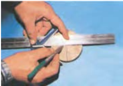
شکل ۶-۱۰۷- استفاده از قطعه‌ی مرکز‌یاب.
