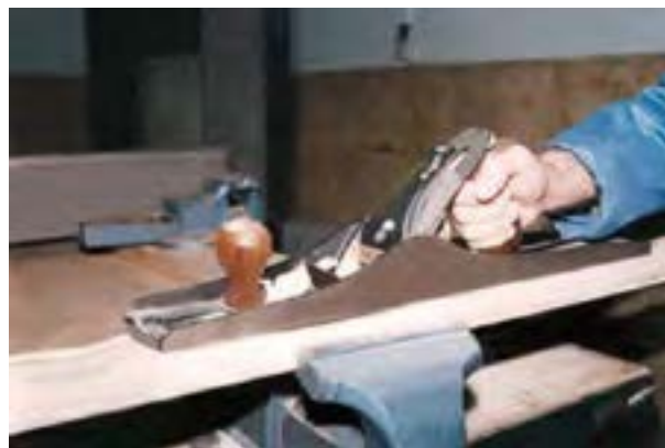
شکل ۶-۸۴- استقرار رنده بلند (دستگاه).
