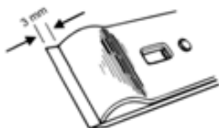
شکل ۶-۷- نمونه‌ی قرار گرفتن پشتی روی تیغه.
