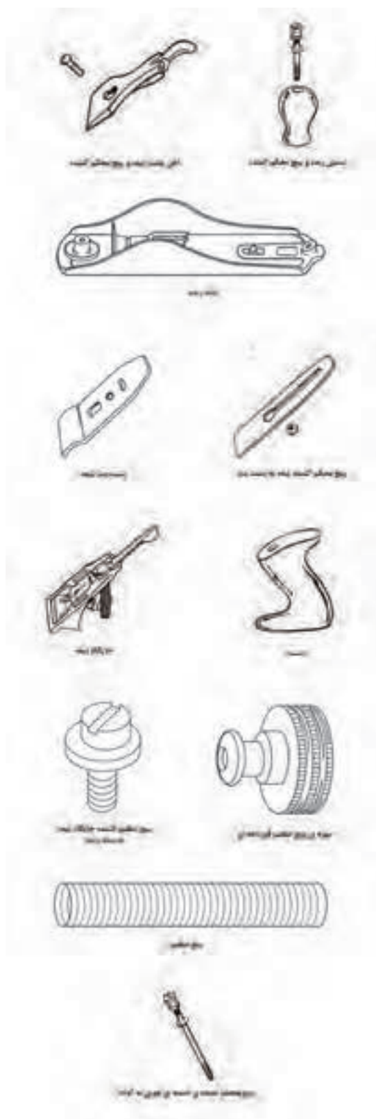
شکل ۶-۵۸- اجزاء رنده
