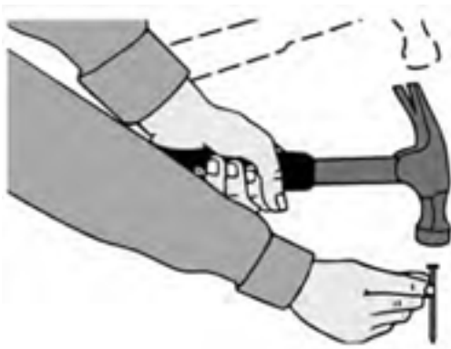
شکل ۷-۳۱- نمونه‌ی گرفتن میخ هنگام کوبیدن.
