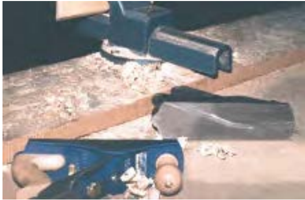
شکل ۶-۹۱- قرار دادن رنده در گودی میز کار.
