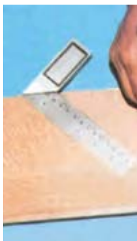
شکل ۶-۱۰۴- خط‌کشی خطوط ۴۵ درجه به وسیله‌ی گونیای معمولی.
