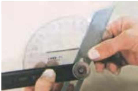
شکل ۱۰۰-۶. استفاده از نقاله در گونیای تاشو.
