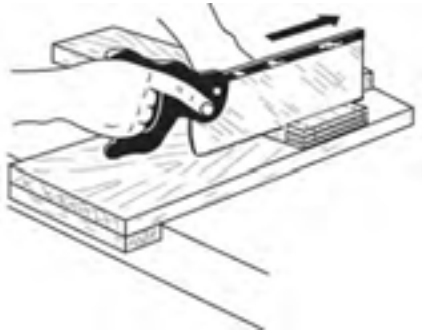
شکل ۵-۵۶. بریدن قسمت‌های اضافی (بر انداختن زبانه).
