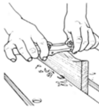
شکل ۶-۴۴- نمونه‌ی رندیدن قوس‌های دافلی.
