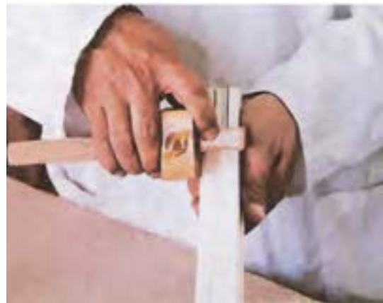
شکل ۵-۵۴. فم‌کشی با استفاده از فم‌کش تیزه‌دار.
