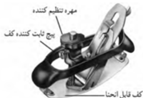
شکل ۶-۴۶- قسمت‌های مختلف رنده کاس و سینه.
