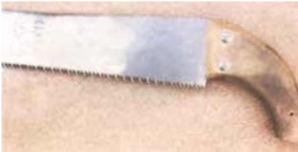
شکل ۵-۳- اره‌ی دندانه‌رو به عقب.
