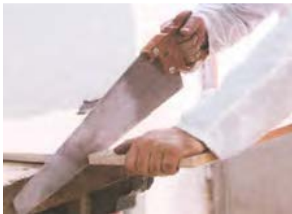
شکل ۵-۸- نمونه‌ی برش به وسیله ارّه دُم روباهی.
