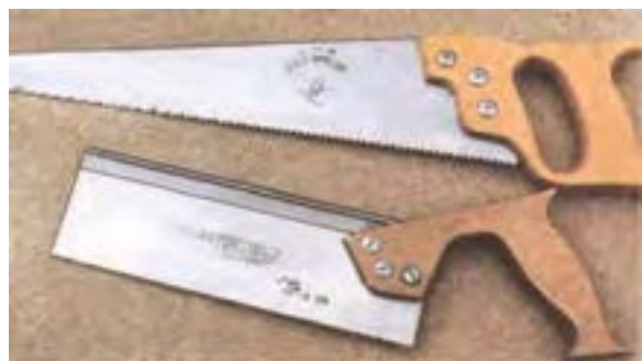
شکل ۵-۲- اره‌های دندانه‌رو به جلو.
