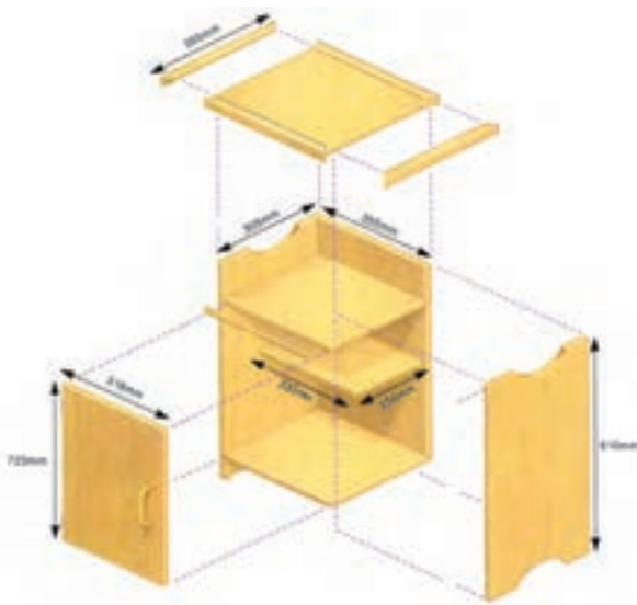
شکل ۳۵-۸ نقشه مونتاز قطعات کابینت
