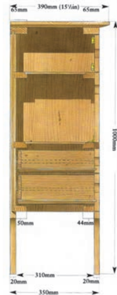
شکل ۵۴ - ۸ برش عمودی از کابینت
