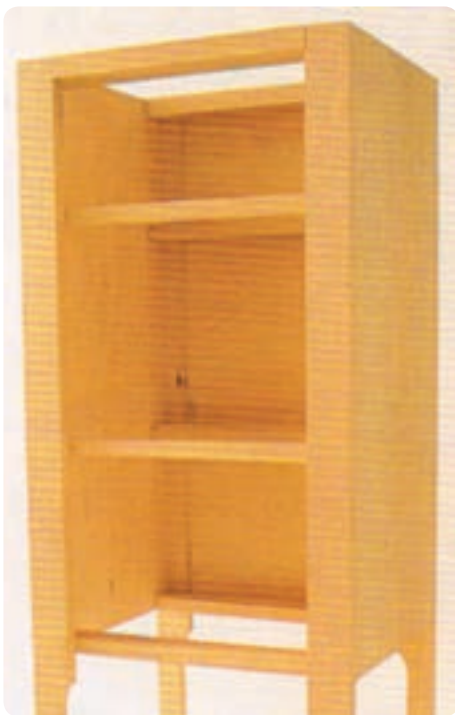
شکل ۸-۶۶ قطعات مونتاژ شده کابینت
