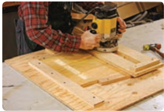
شکل ۳-۲۹ شابلون تسریع کننده و حفاظتی اورفرز
