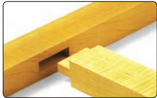
شکل ۴-۳۶ اتصال کُم و زبانه مخفی (یک طرفه)
