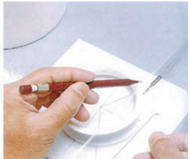
۱۸- اندازه خواسته شده روی رینگ گچی مشخص می گردد.
