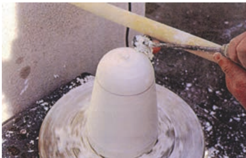
۳- بالای مدل تا زمانی که به فرم مطلوب برسد به این طریق تراشیده می‌شود.
