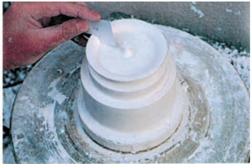
۱۵- ایجاد انحنا - میزان انحنا لبه کار با شابلون بررسی می شود.
