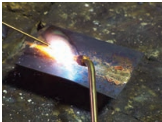
شکل ۴-۷- ایجاد گاز در اطراف محل لحیم کاری
