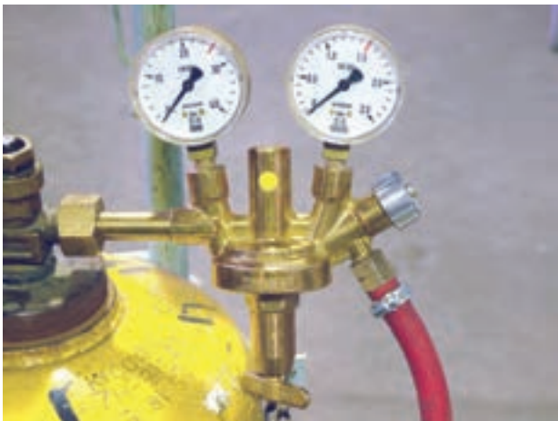
شکل ۱۳۵-۲ پیچ تنظیم فشار استیلن روی رگولاتور
