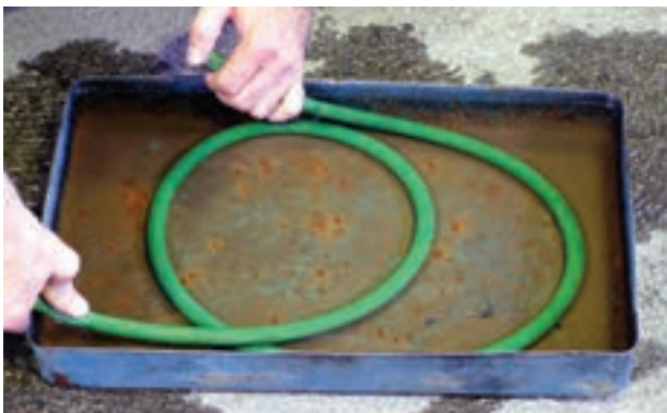
شکل ۲-۹۹- کنترل نشتی شیلنگ در آب
