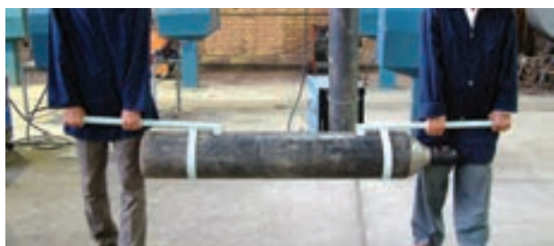
شکل ۸۶-۲ روش درست جابه‌جا کردن کپسول
