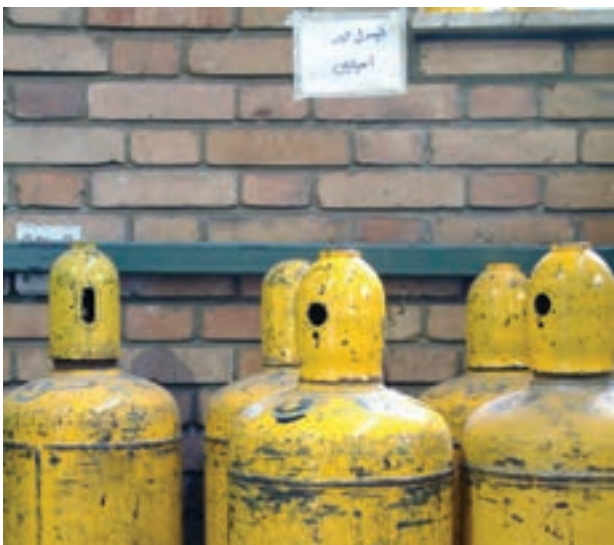
شکل ۸۹-۲ انبار کردن کپسول
