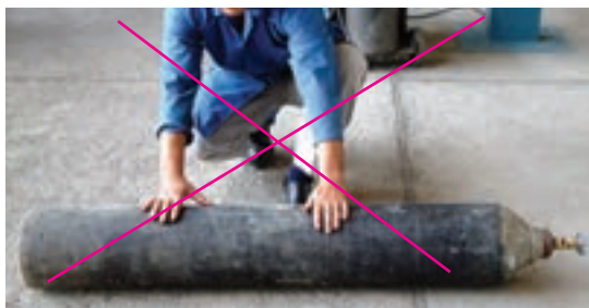
شکل ۲-۸۴ – کار اشتباه در حمل کپسول
