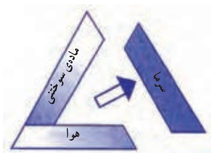
شکل ۱۵-۱- سرد کردن ماده‌ی سوختنی
