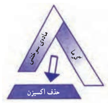
شکل ۱۶-۱- ممانعت از رسیدن اکسیژن به ماده‌ی سوختنی
