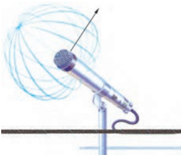
شکل ۱-۱۲۵- منحنی مشخصه میکروفون
