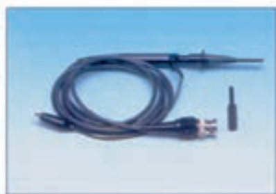
شکل ۸۵-۱ کاربرد کابل کواکسیال در پراب اسیلوسکوپ
