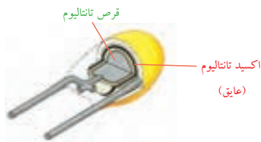
شکل ۷-۲۱ خازن تانتالیوم
