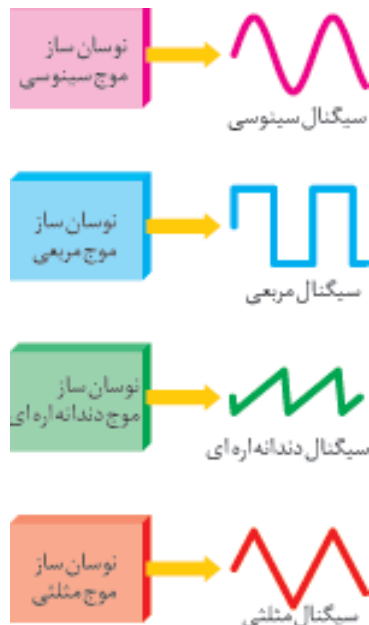
شکل ۸-۲ انواع نوسان سازها با توجه به شکل موج تولیدی
