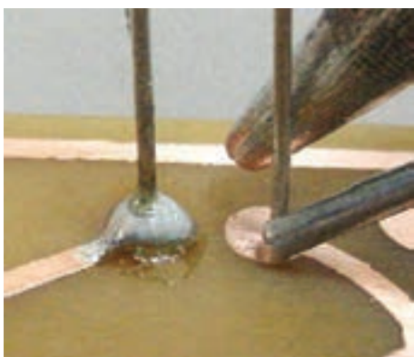
شکل ۷-۱۰ مونتاژ قطعات روی فیبر
