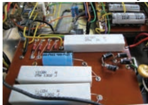
شکل ۷-۱ فیبر مدار چاپی به روش قدیمی
