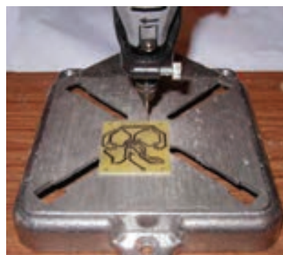
شکل ۷-۸ سوراخ کاری با دریل برقی
