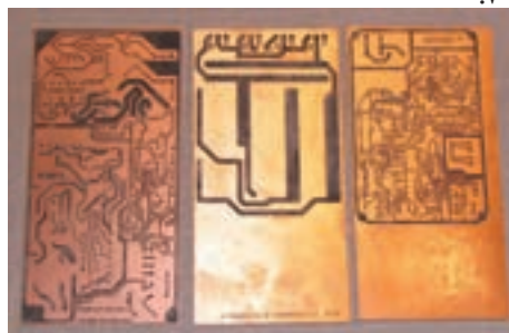
شکل ۷-۶ انتقال مدار چاپی روی فیبر
