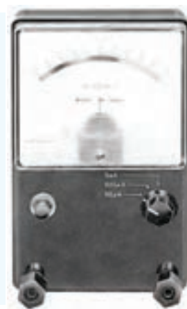
شکل ۲۶-۳: یک نمونه گالوانومتر صفر وسط
