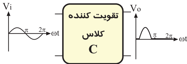
شکل ۳-۶ تقویت کننده کلاس C
