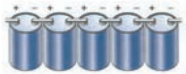
شکل ۲-۱۲۰ اتصال سری پیل‌ها
