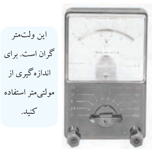
شکل ۹۱-۲ ولت‌متر عقربه‌ای
