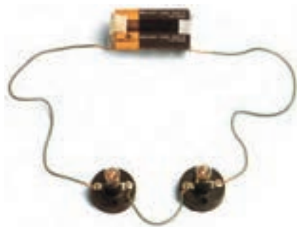
شکل ۲۹-۲ مدار واقعی دو لامپ به صورت سری
