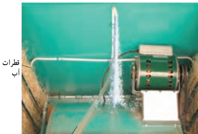
شیلنگ رابط پمپ و سه راهی
