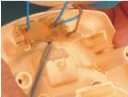
ب - پلاتین‌ها در حالت وصل
