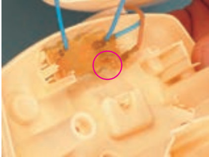
الف - پلاتین‌ها در حالت قطع
