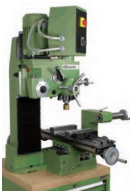
یک نمونه فرز عمودی
