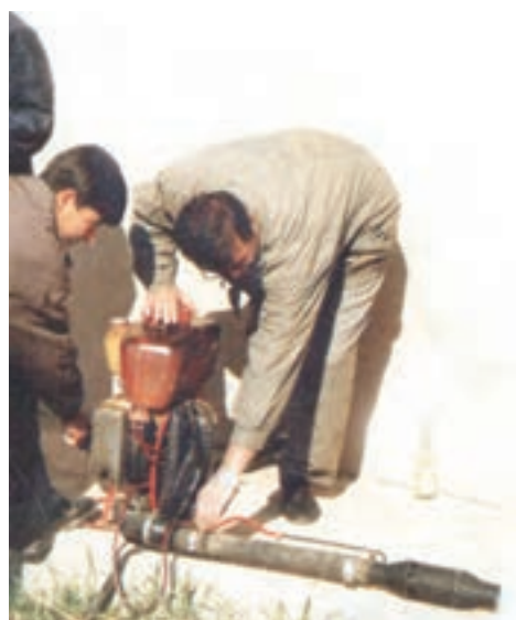
شکل ۲۵-۳- آماده سازی و روشن کردن شعله افکن
