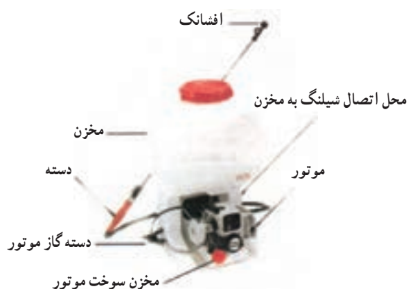
شکل ۲۸-۳- سم‌پاش موتوری پشتی لانس‌دار
