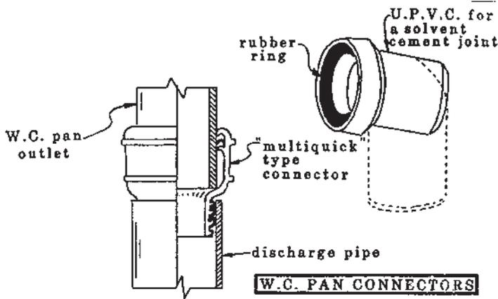
شکل ۳-۲۴۰- طریقه اتصال توالت فرنگی به لوله فاضلاب
