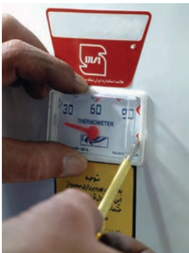
شکل ۱۱۶-۱ جدا کردن طلق ترمومتر
