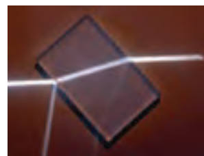
شکل ۳-۴۵ در عبور یک پرتوی نور از محیطی شفاف به محیط شفاف دیگر، بخشی از نور بازمی تابد و بخشی می شکند.
