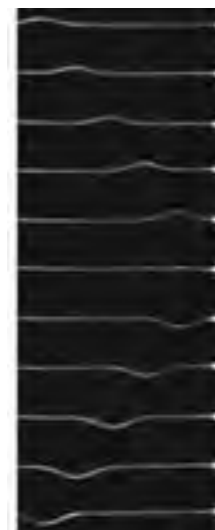
شکل ۳-۴ چند تصویر لحظه‌ای متوالی از پیشروی و بازتاب یک تب عرضی در یک فنر بلند کشیده شده که یک سر آن در تکیه‌گاهی واقع در سمت راست، ثابت شده است.
