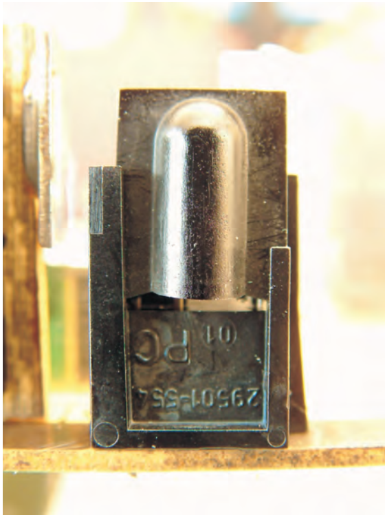
شکل ۳-۱۴ آی سی گیرنده مادون قرمز
