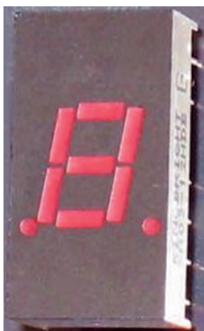
شکل ۲-۲۱۲- واحد نمایش یک رقمی و دورقمی
