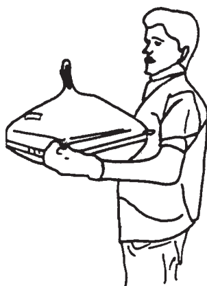
شکل ۱-۱۳۳- روش صحیح حمل تلویزیون
