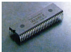
شکل ۱۰۹-۲ یک آی‌سی PROM
