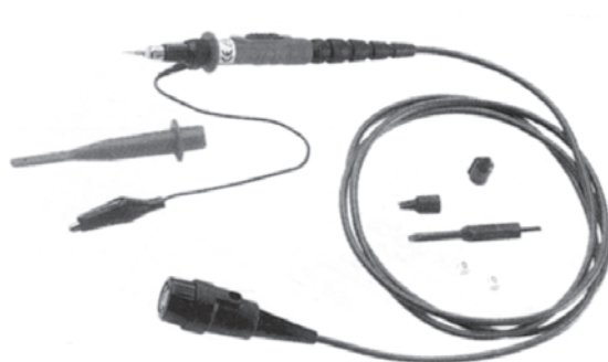
شکل ۱۳۸-۱- پراب با ضریب \times 10 برای اندازه گیری ولتاژ بالا
