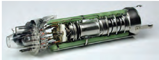
شکل ۱-۵ تفنگ الکترونی تلویزیون رنگی
