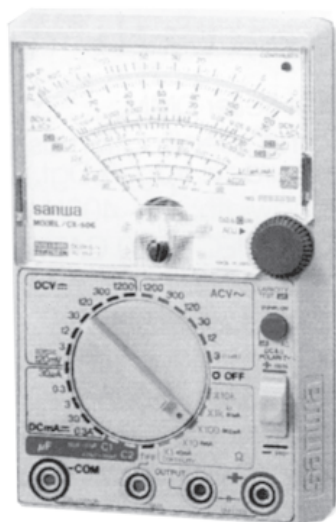
شکل ۲-۷۹- یک نوع مولتی متر عقربه‌ای
