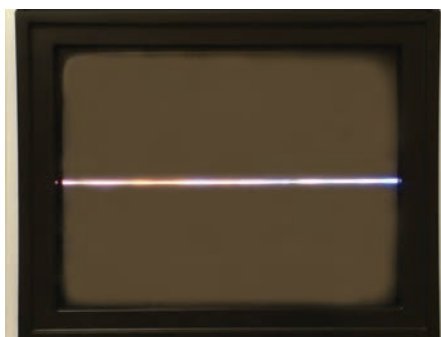
شکل ۲-۴۰ - نوسان ساز عمودی از کار افتاده است.
