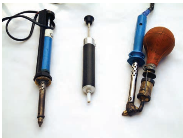
شکل ۴-۷۹- قلع‌کش حرارتی و پیستونی
