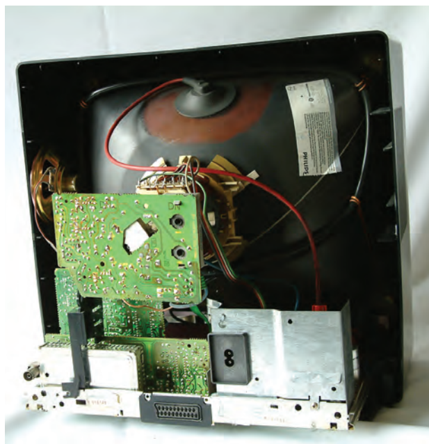
شکل ۴-۳۵- تلویزیون بدون قاب پشت
