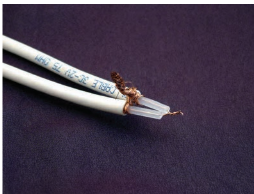
شکل ۱-۶۳- سیم کابل نباید دو تکه باشد.
